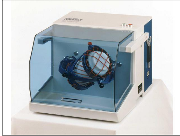
Şekil 4.1. Turbula karıştırma makinesi.
