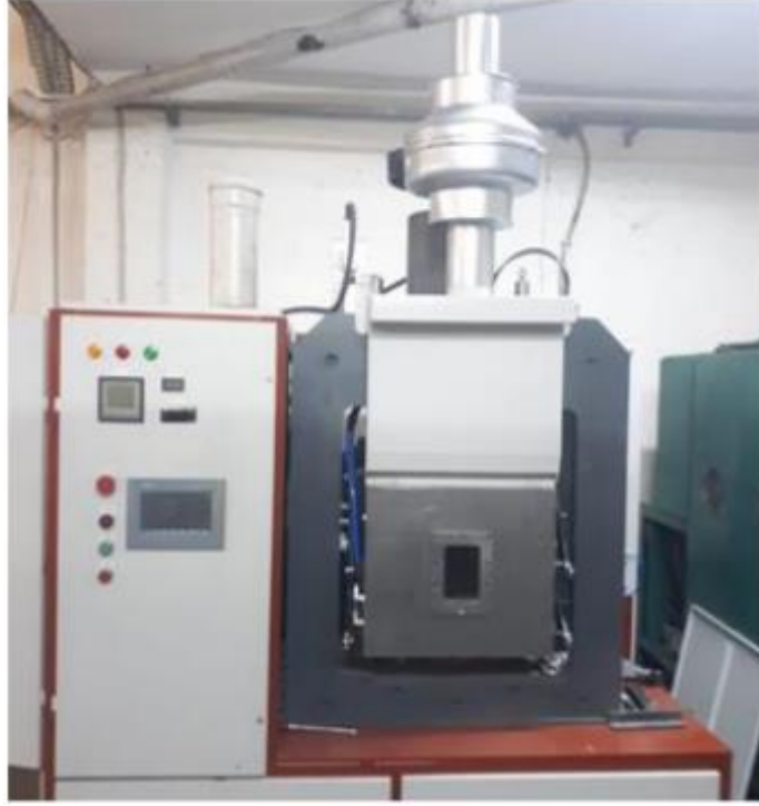
Şekil 4.2. PLC kontrollü sıcak pres makinesi.
