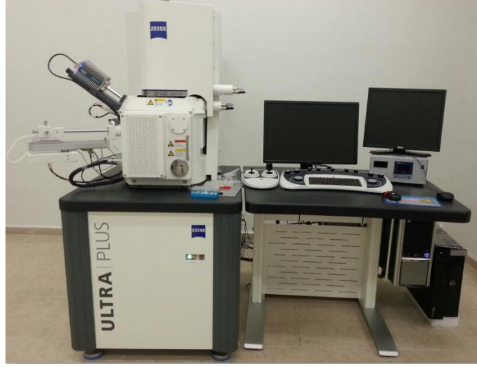
Şekil 4.6. CARL ZEISS ULTRA PLUS GEMINI FESEM analiz cihazı.
