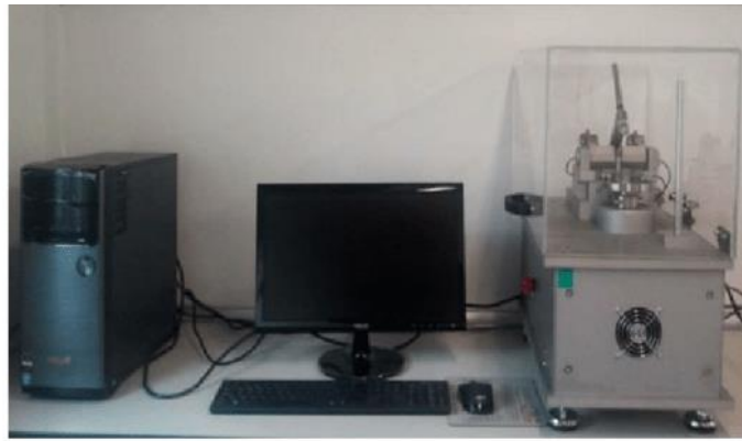
Şekil 4.9. UTS Tribometer T 10/20 marka aşınma cihazı.
