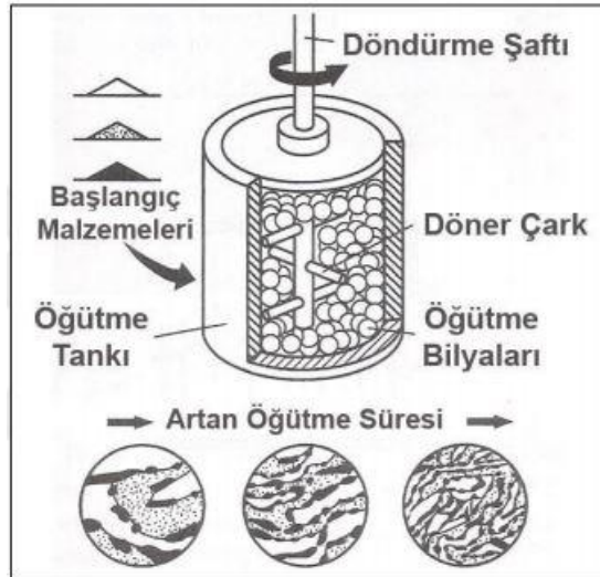
Şekil 2.3. Mekanik alaşımla elemanları ve öğütme süresi ile değişen tozların şematik gösterimi [15].
