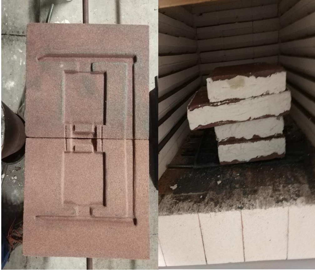
Şekil 3.16. Kalıpların döküm öncesi birleştirilerek neminin alınması
