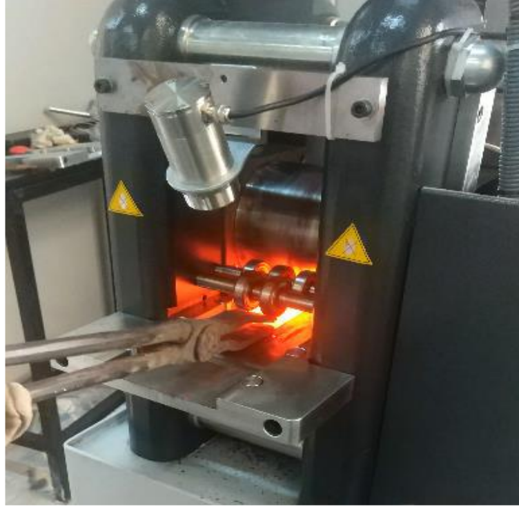
Şekil 6.12. Labaratuvar ortamında yapılan haddeleme işlemi
