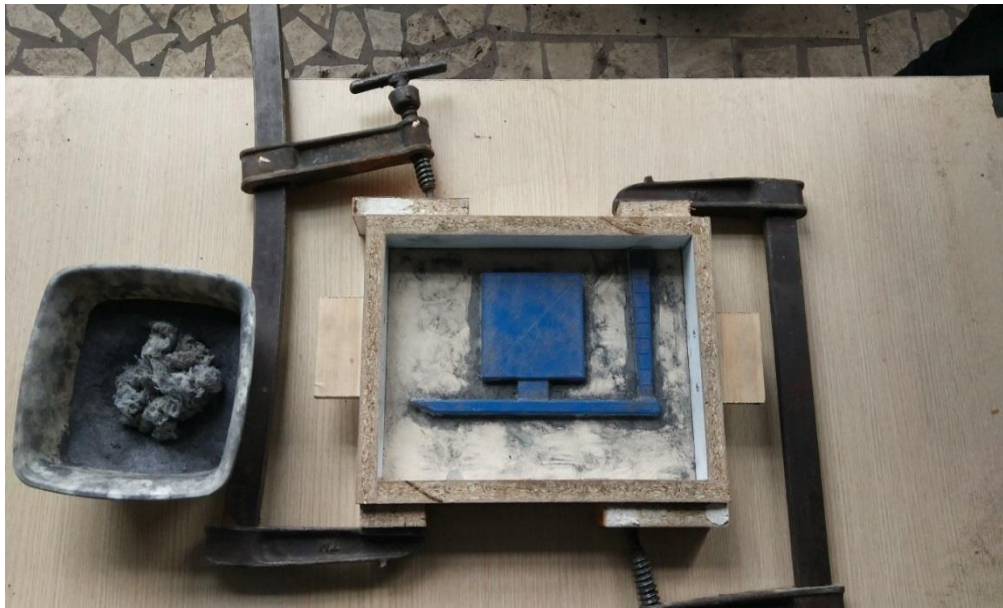
Şekil 3.12. Model ve derecenin sabitlenip kum kalıp öncesi grafitleme
