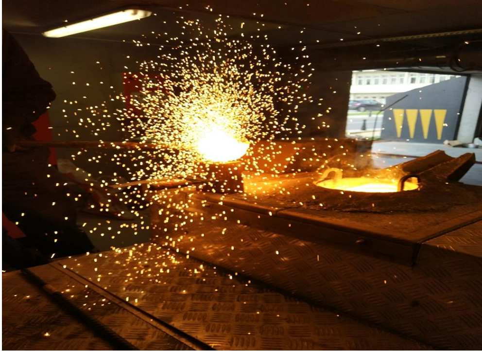
Şekil 6.7. Döküm indüksiyon fırını numune alımı
