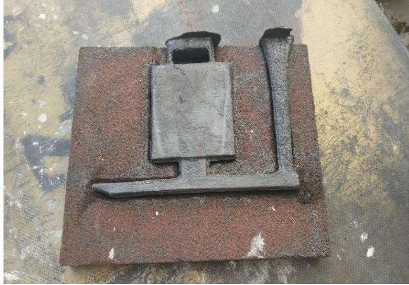
Şekil 6.9. Döküm sonrası kalıbın bozulması-temizlenmesi
