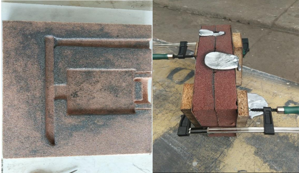
Şekil 3.15. Kum kalıbın modelden ayrılmış hali ve alüminyum dökümü kalıbın denenmesi
