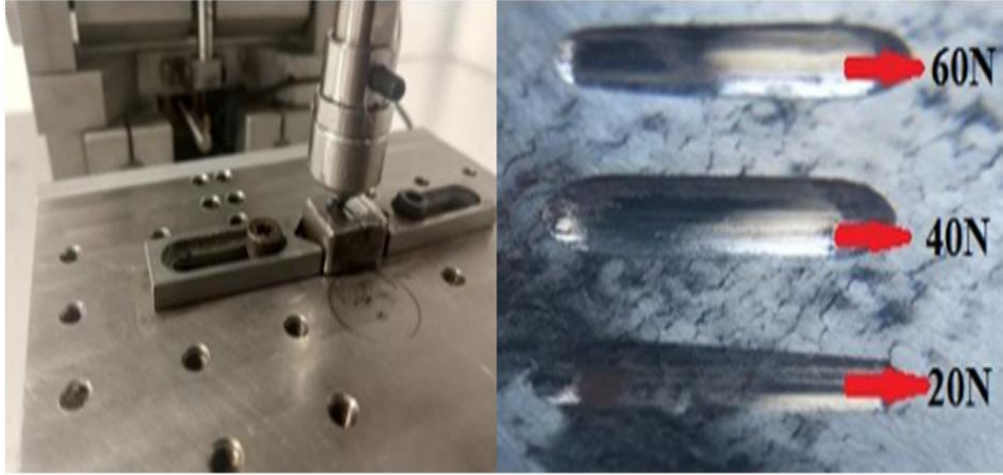
Şekil 6.23 Aşınma testi sonrası uygulanan yük miktarına bağlı olarak aşındırılmış numunenin görünümü
