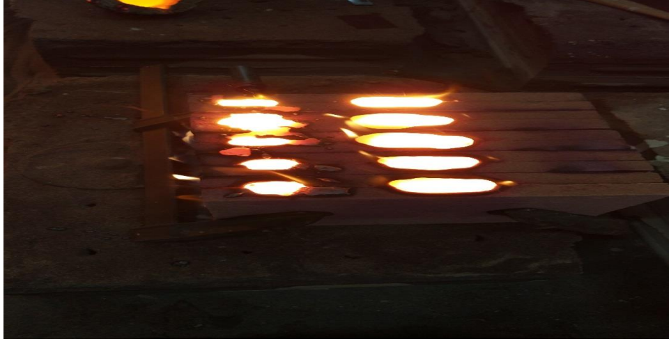
Şekil 6.8. Kum kalıpların döküm sonrası görüntüsü
