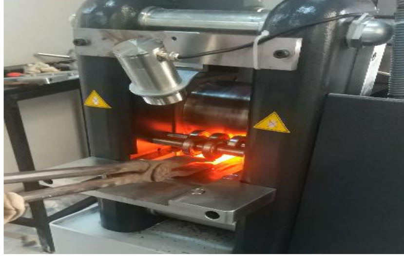
Şekil 4.1. Haddeme prosesi görünümü
