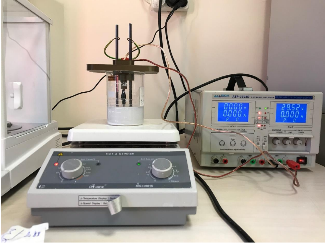
Şekil 3.18. Kaplama yapılırken EPD sistemi.
