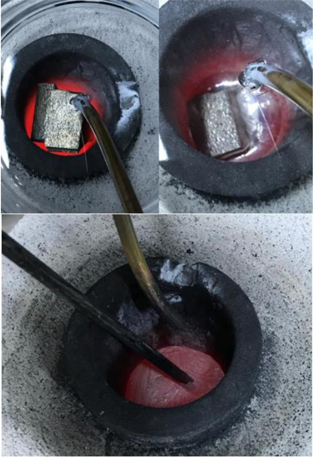
Şekil 3.15. Ergime esnasında magnezyum alaşım.
