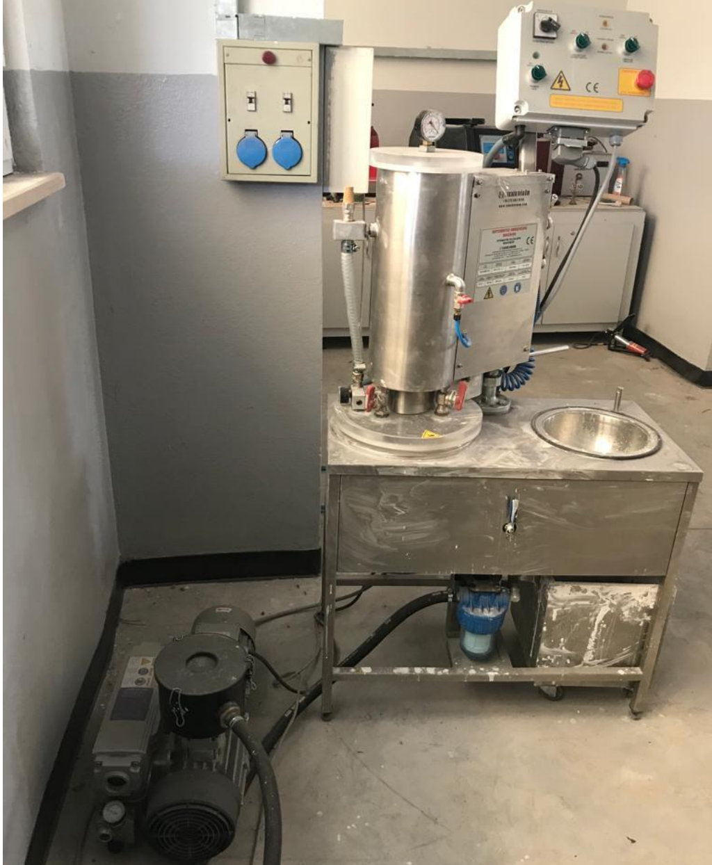
Şekil 3.12. Otomatik alçılama makinası.
