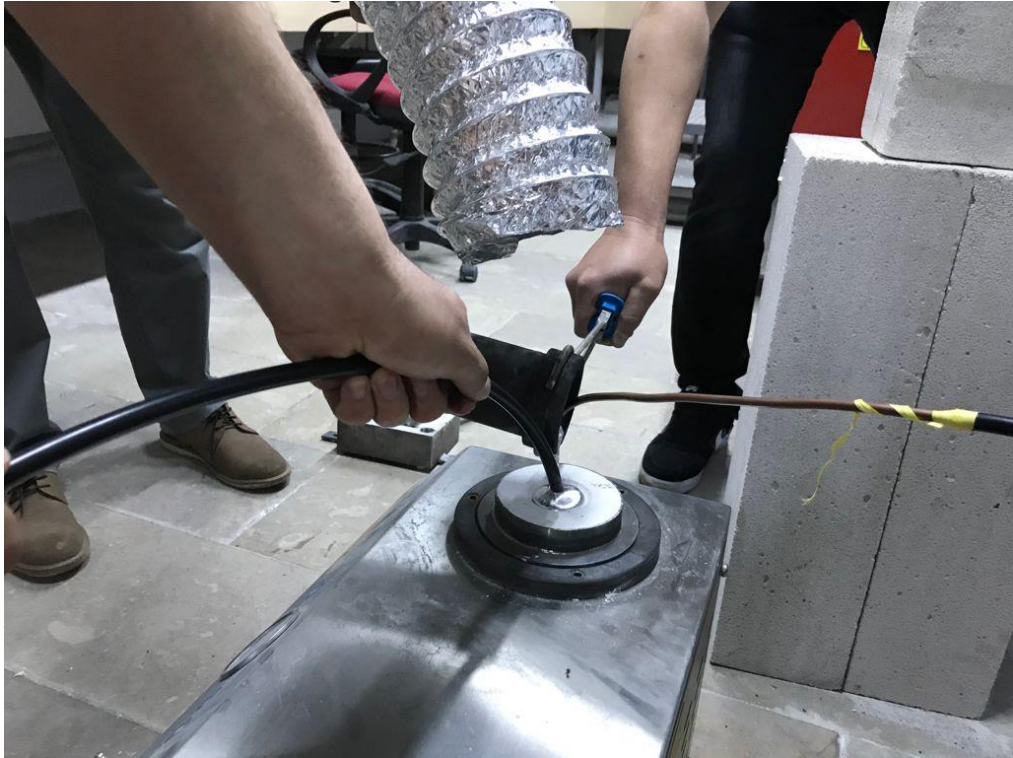
Şekil 3.16. Seramik kalıba döküm anı.
