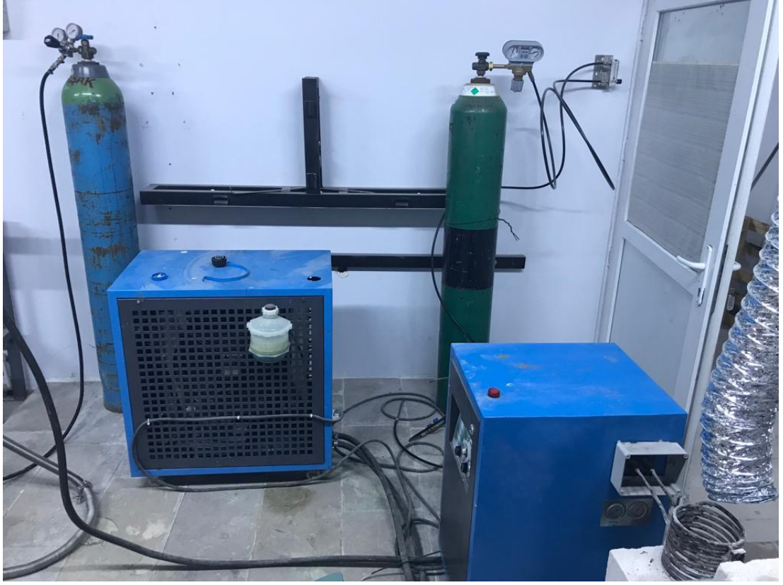
Şekil 3.14. Magnezyum ergitmede kullanılan indüksiyon fırını.
