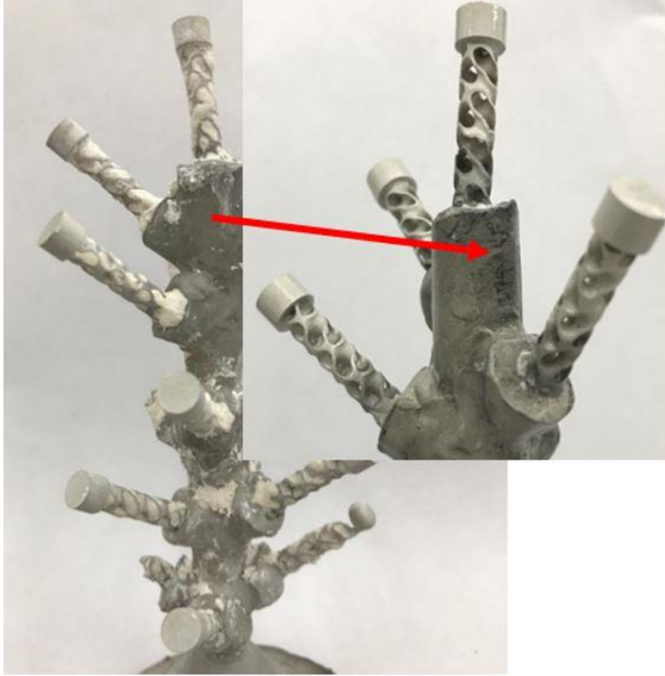
Şekil 4.2 . Seramik kalıptan ayrılan döküm parçası.
