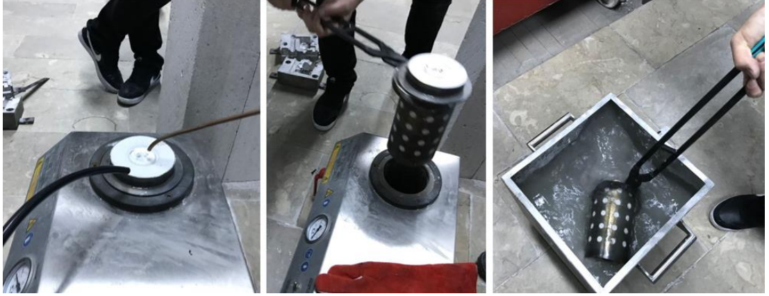
Şekil 3.17. Döküm sonrası alçı çözündürme işlemi.
