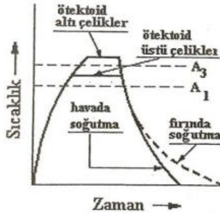
Şekil 4.8. Normalizasyon ısıl işlemine ait zaman-sıcaklık diyagramı [52].
