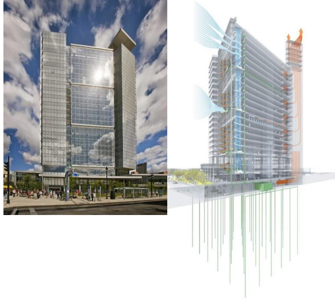
Şekil 5.3. Manitoba Hydro ofis binası genel görünüm ve uygulanan havalandırma, ısıtma ve soğutma sistemi [71].
