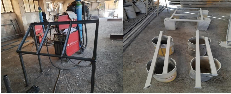
Şekil 4.6. Taşıyıcı sistem imalatı.
