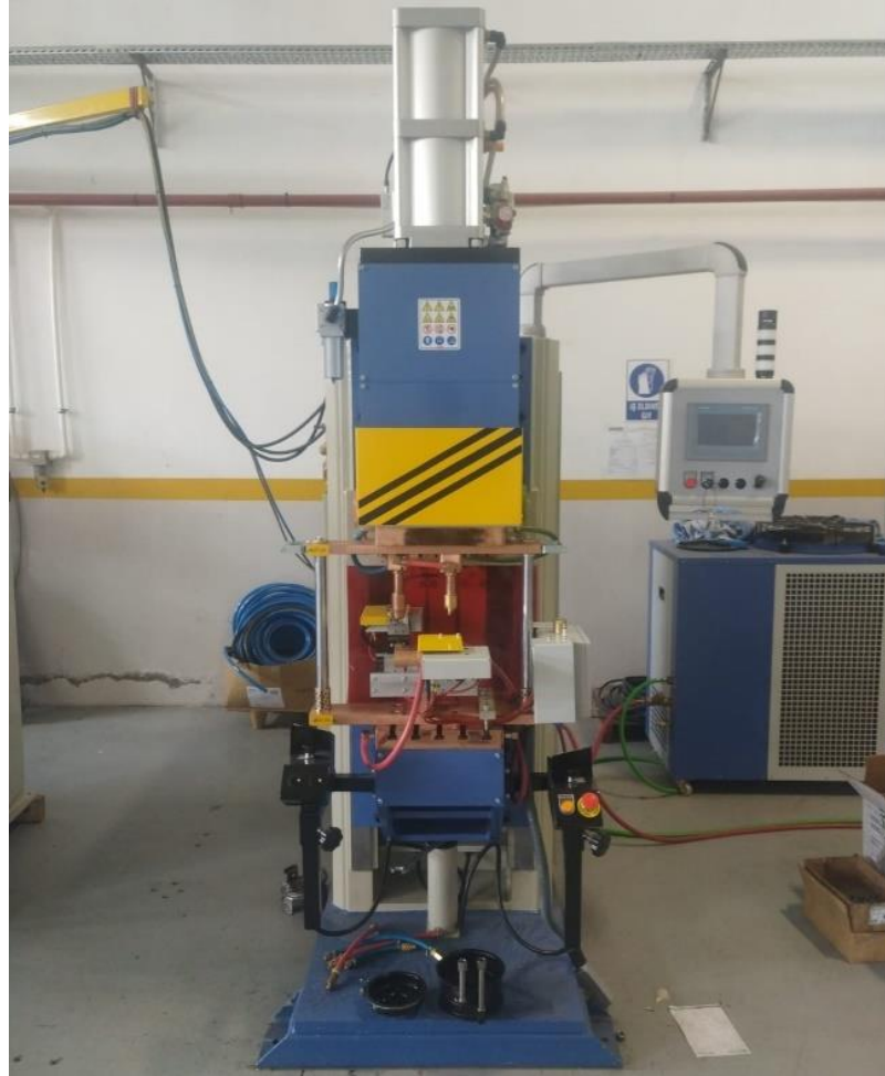
Şekil 4.2. Kaynak işlemlerini gerçekleştirdiği MFDC makine.
