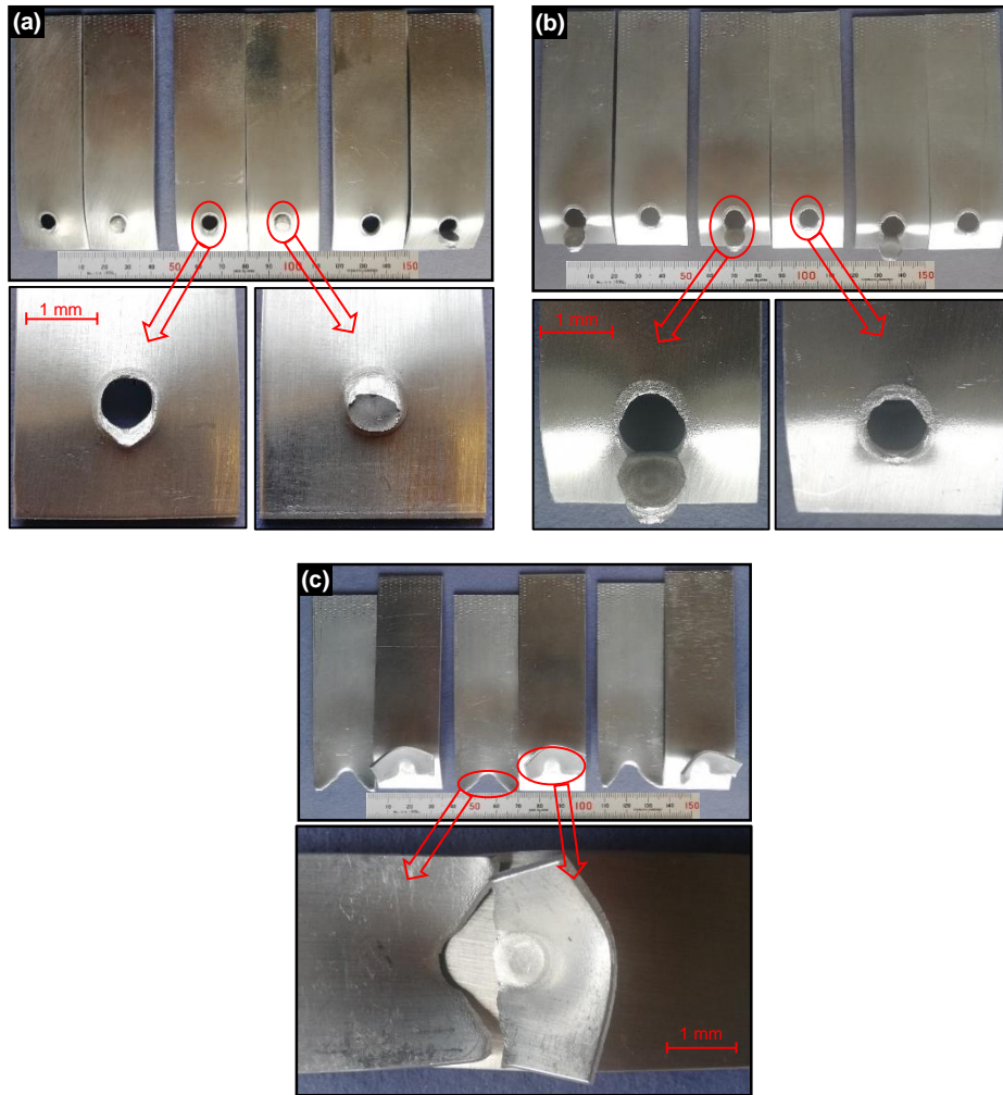
Şekil 5.11. Çekme-makaslama testi sonrası kopma görüntüleri.
