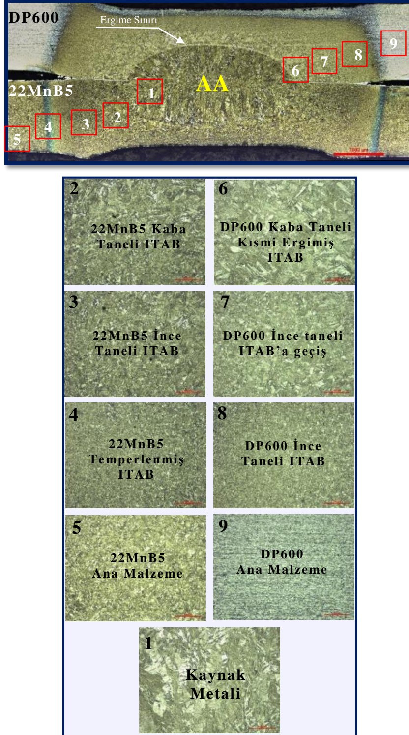
Şekil 5.3. BHS uygulanmamış AA ile üretilen numunelerin makro/mikroyapıları.
