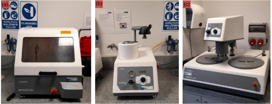
Şekil 4.15. Kesme, bakalite alma ve parlatma işlemlerinin yapıldığı cihazlar.
