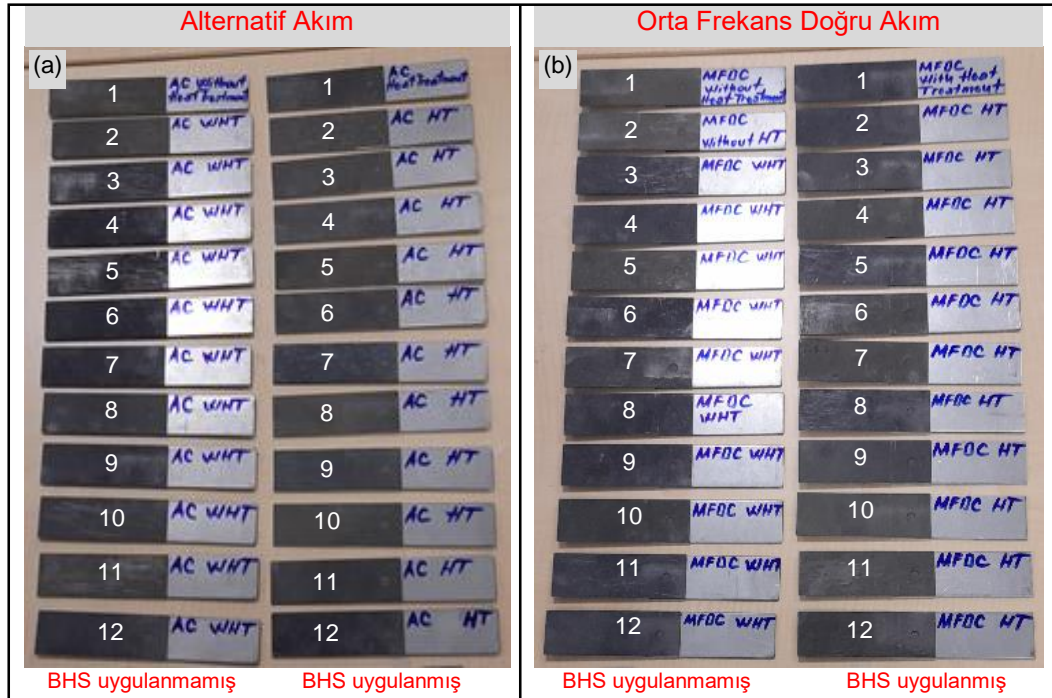
Şekil 4.21. Yorulma testleri için nokta direnç kaynağı ile birleştirilen numuneler.
