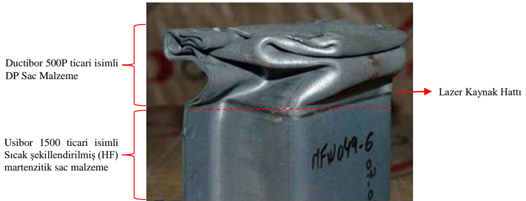
Şekil 2.2. Usibor 1500 ve Ductibor 500 lazer kaynaklı bağlantının darbe davranışı testi sonuç görseli [10].
