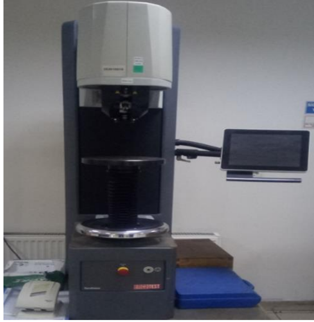
Şekil 5. 4. Sertlik ölçüm cihazı.
