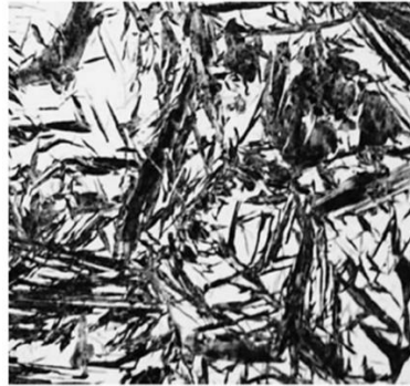
Şekil 4. 8. Martenzit fazı görünümü [43].
