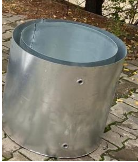
Şekil Ek A.4. Galvanizli saçtan yapılan termal depo.
