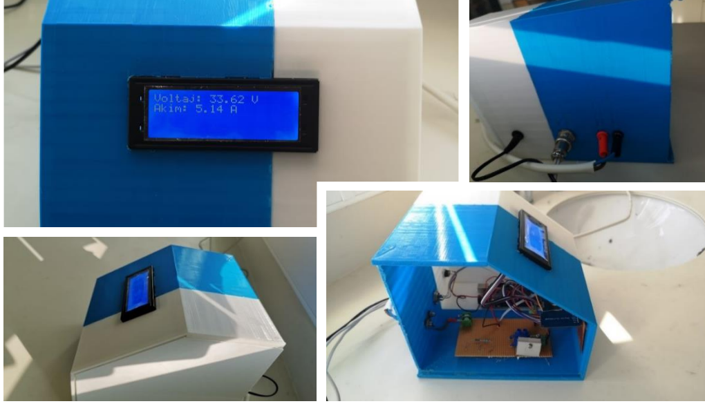
Şekil 5.2. FV/T sistem ölçüm cihazının iç ve dış görüntüsü.
