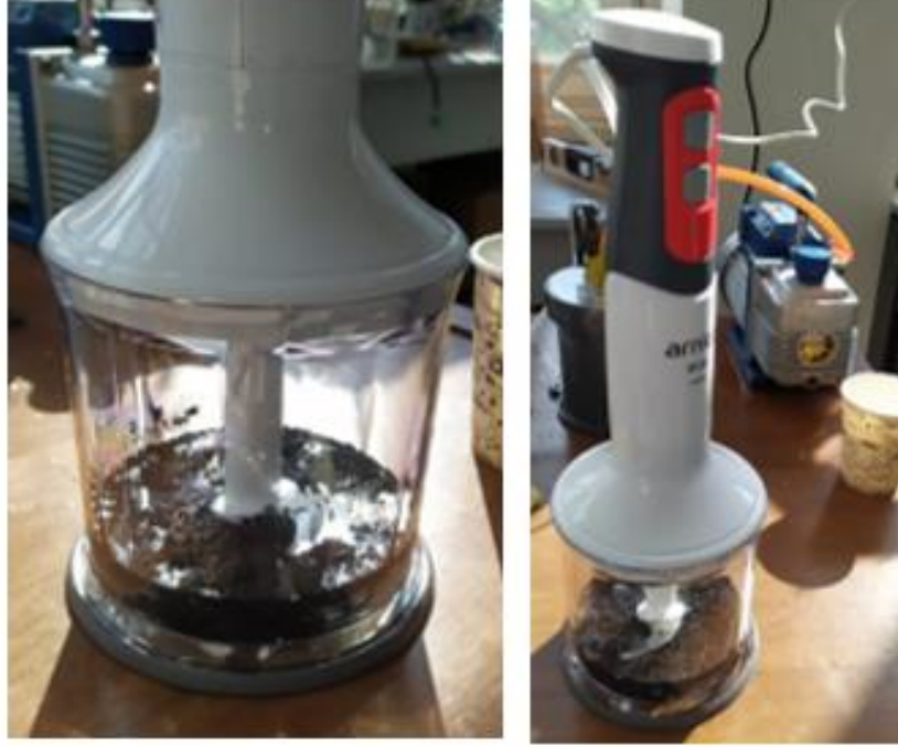
Şekil 6.7. Reçine ve grafen karıştırma işlemi.
