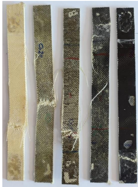
Şekil 6.18. Numunelerin çekme testinden sonra görüntüleri.
