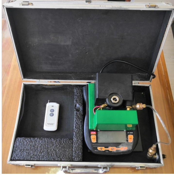
Çizelge Ek G.1. Soğutucu akışkan şarjı ve tartı mekanizması.
