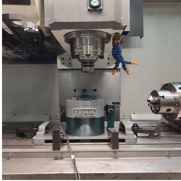
Şekil 5.11. Delik delme işleminin fotoğraf görüntüsü
