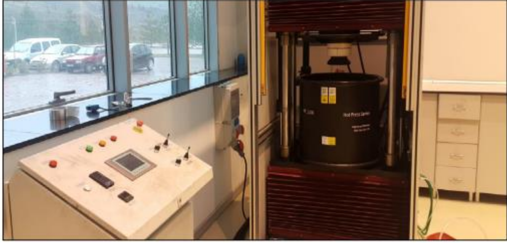
Şekil 5.7. FML'lerin üretildiği sıcak pres cihazı.
