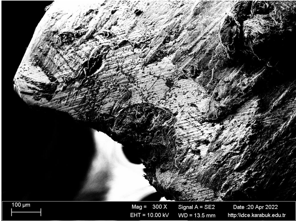
Şekil 6. 99. 100° matkap ucunun 300X büyütme SEM görüntüsü
