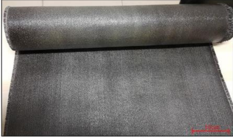
Şekil 5.2. PEEK emprenye edilmiş dokuma karbon fiber prepreg görüntüsü.
