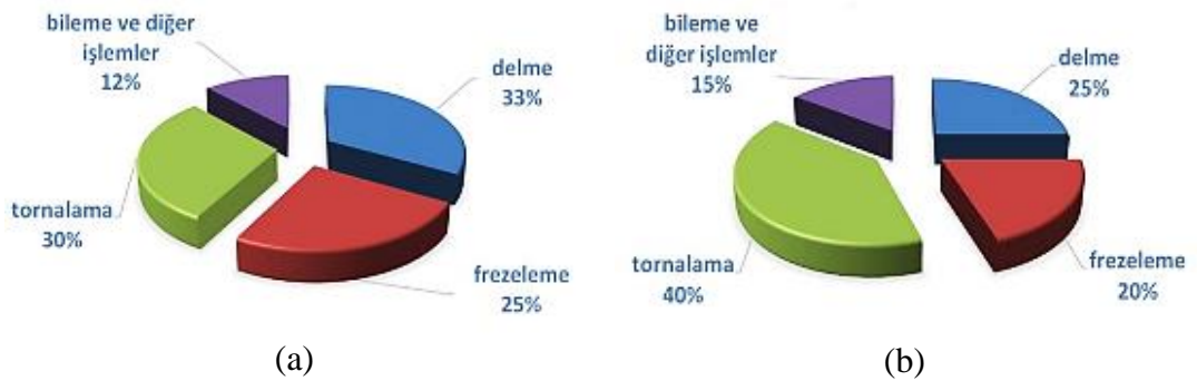
Şekil 2.3.Talaş kaldırma işleminin (a) işlem süresi ve (b) talaş kaldırma süreleri[44].
