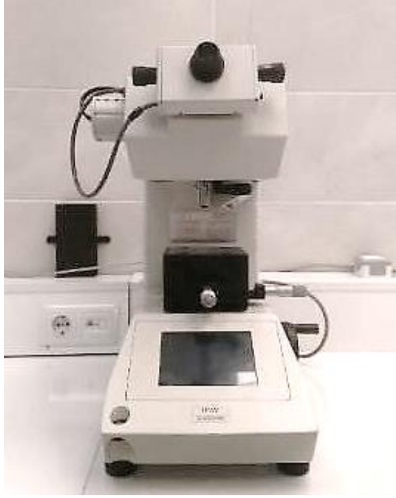
Şekil 4.42. Vickers mikrosertlik cihazı.
