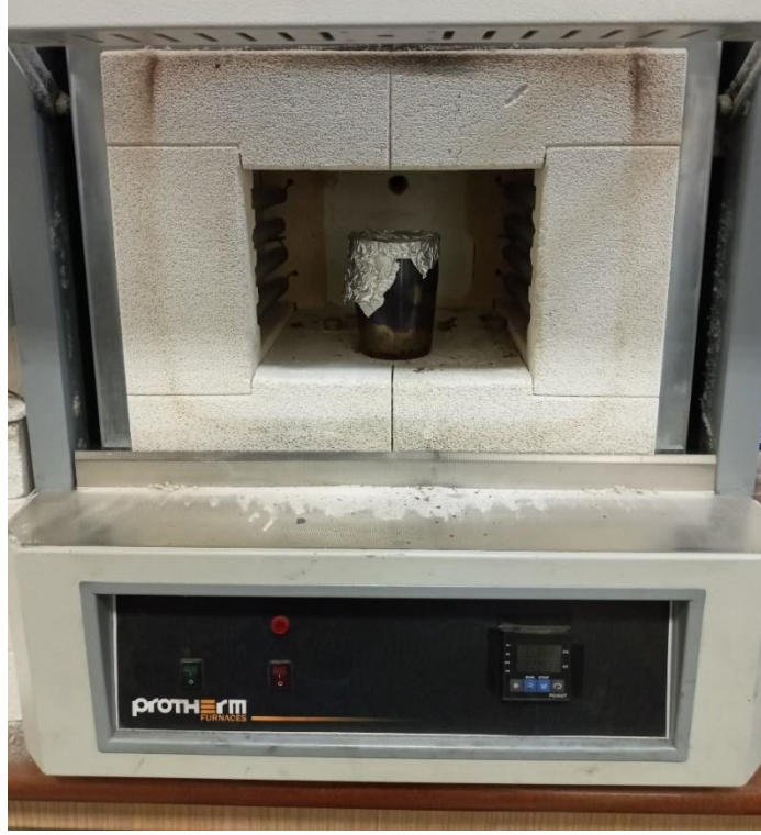
Şekil 3.35. Sinterleme işlemi için numunelerin fırına yerleştirilmesi.
