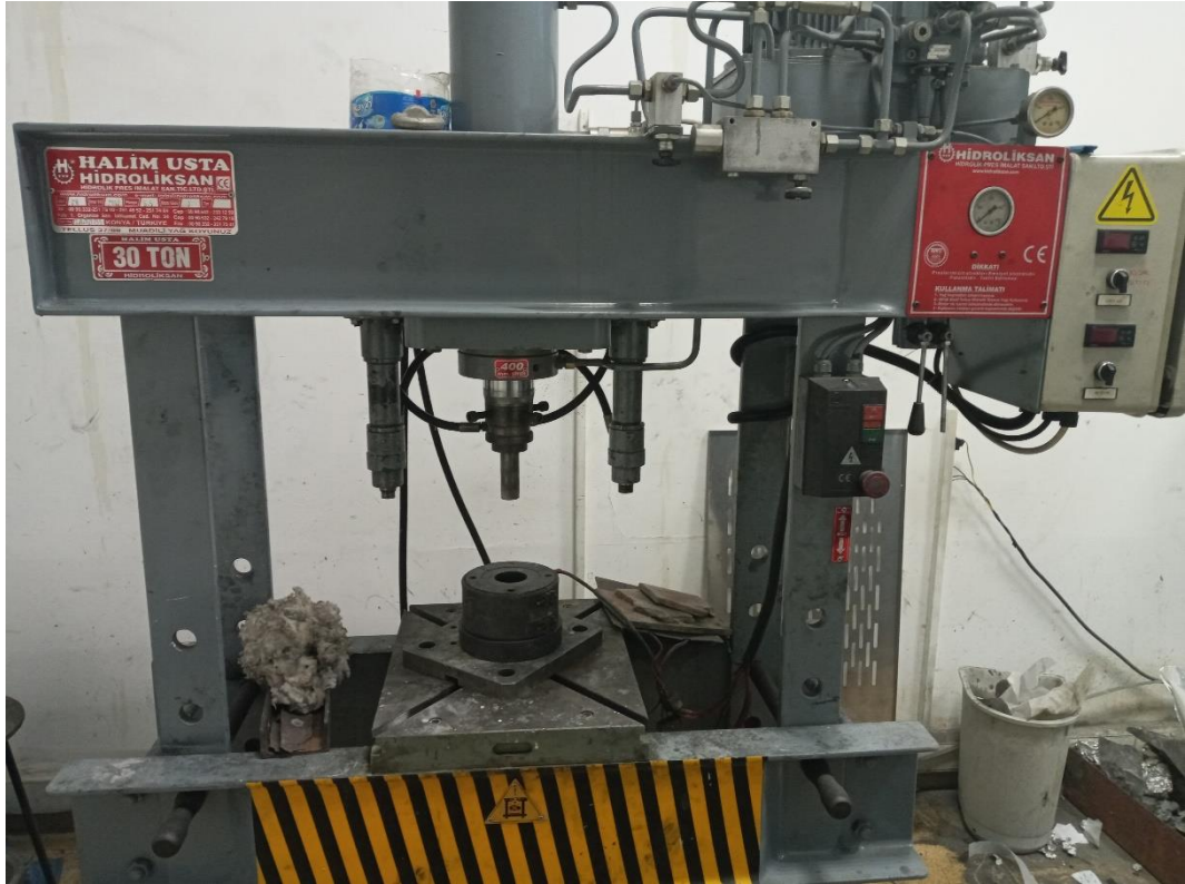
Şekil 3.22. H tipi pres makinesi.
