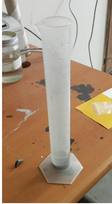
Şekil 4.11. Arşimet prensibine göre yoğunluk hesabını yapmak için kullanılan beher.
