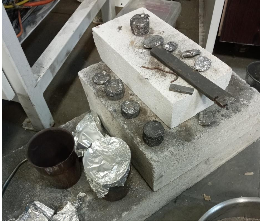
Şekil 3.36. Sinterleme sonrası numunelerin fırından çıkartılması.
