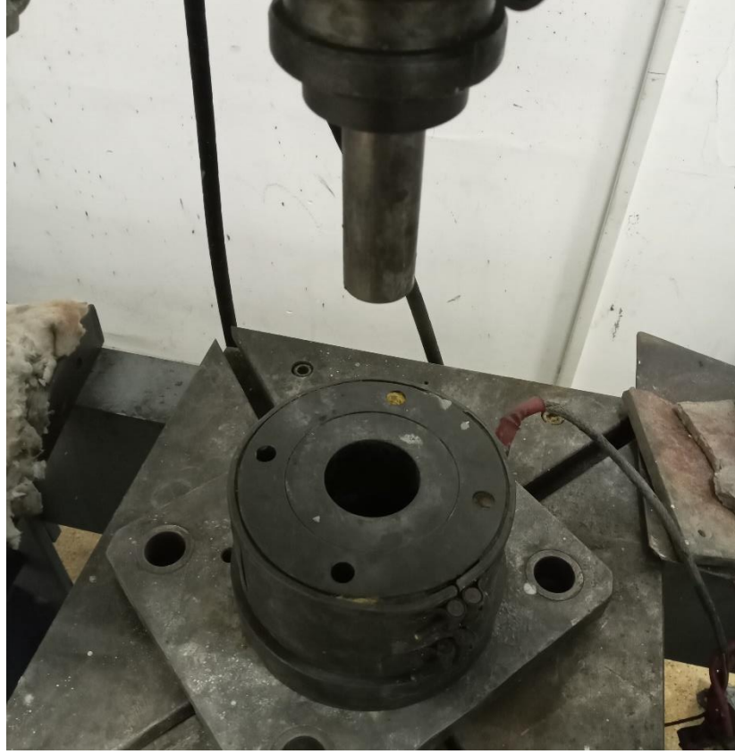
Şekil 3.22. Numuneler için silindirik kalıp.
