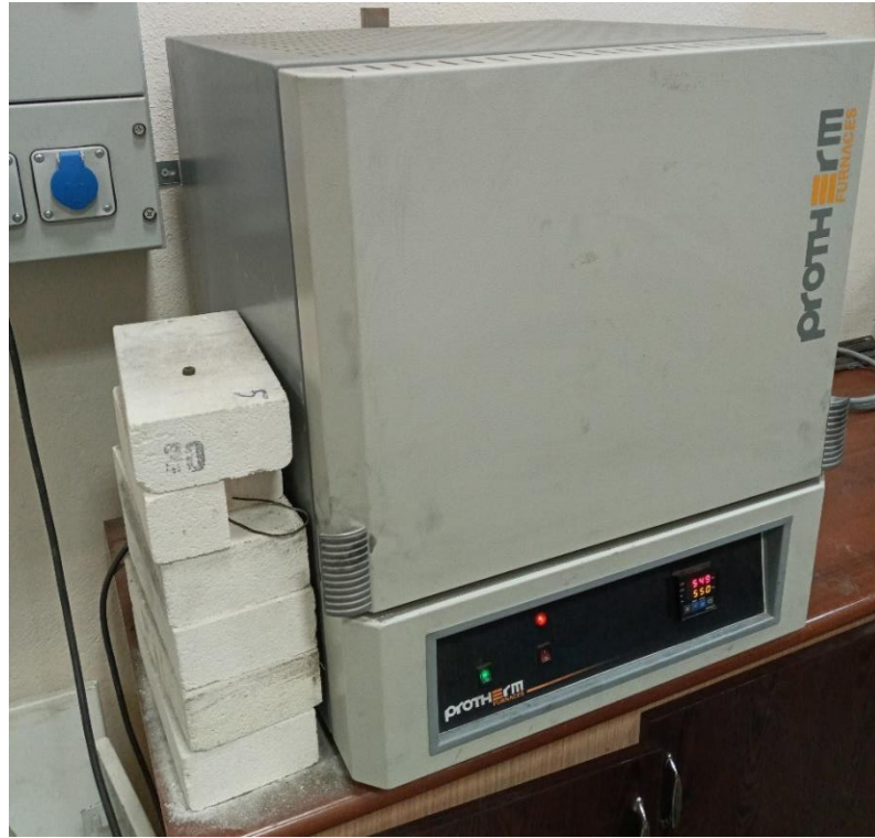
Şekil 3.34. Sinterlenecek numuneler için kullanılan fırın.
