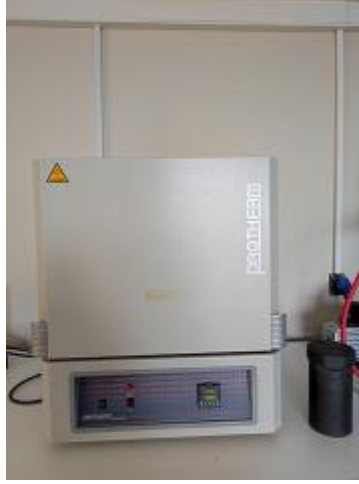
Şekil 6.2. Borlama deney işleminde kullanılan protherm PLF 120/5 marka ısıtma fırını.
