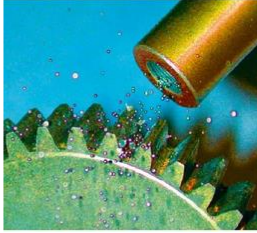
Şekil 3.6. Bir dişilin bilyalı dövülmesi işlemi [31].
