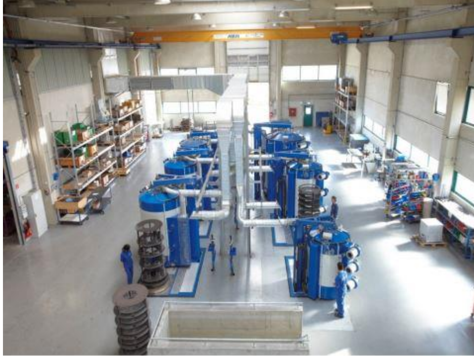
Şekil 3.3. Modern ticari plazma nitrüleme hattı [19].
