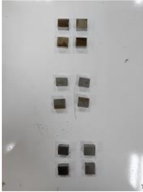
Şekil 6.1. Borlama deney işleminde kullanılan St 37 numune malzemeleri.
