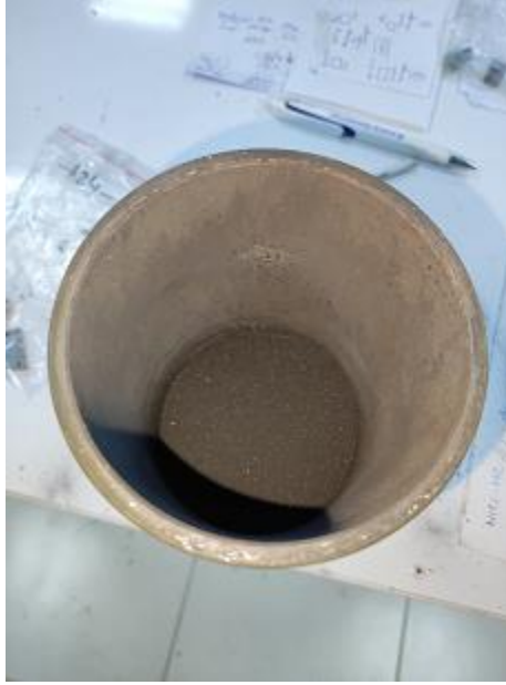
Şekil 6.3. Borlama deney işleminde kullanılan kova.
