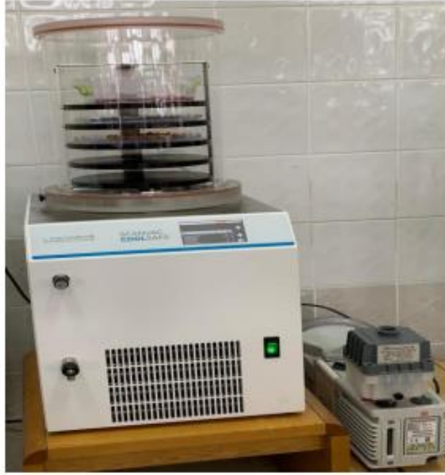
Şekil 8.13. Kanlıca mantar numunelerinin kurutulduğu cihazın görünümü.
