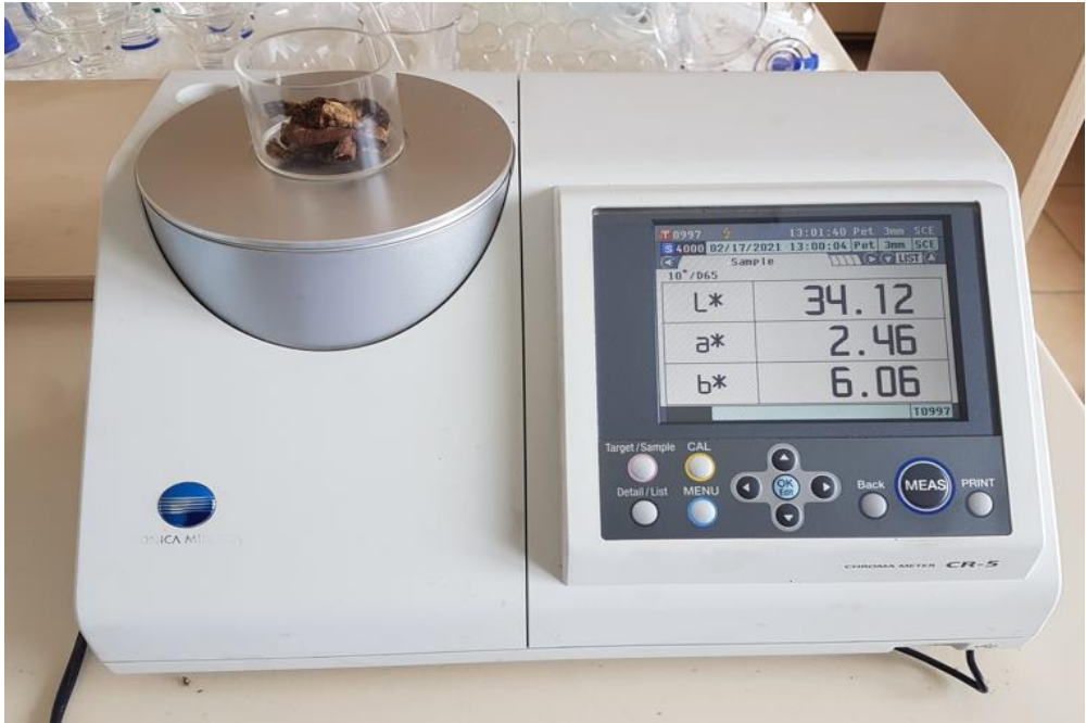
Şekil 8.10. Model CM-5 Sektrofotometre.
