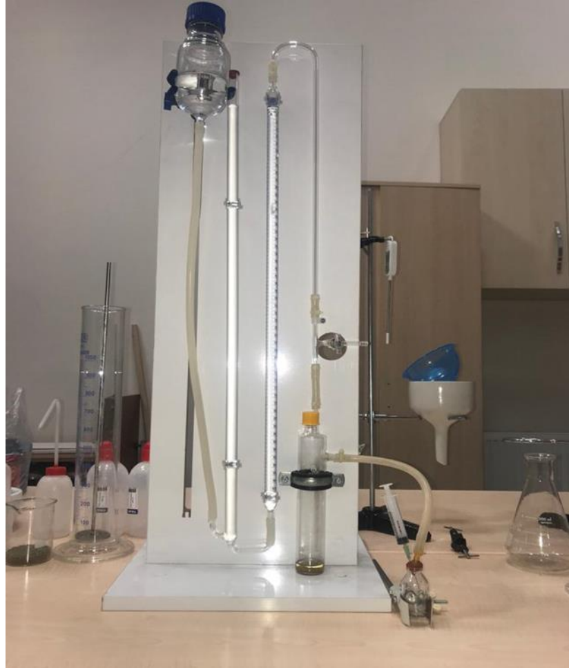
Şekil 3.8. Scheibler Kalsimetresi (Sönmez vd., 2020).
