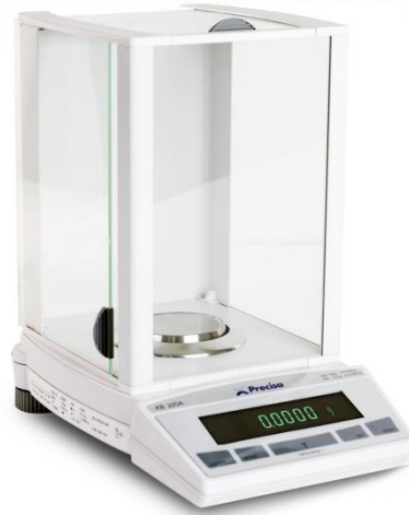
Şekil 5.7. Deneylerde kullanılan PRECISE XB 220A markalı hassas terazi.
