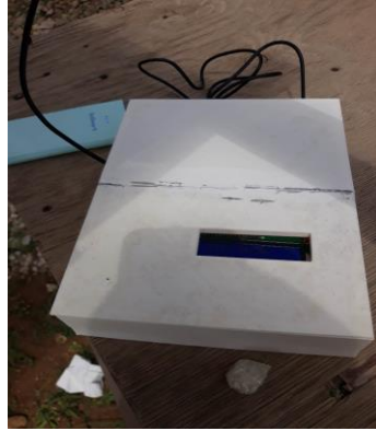
Şekil 5.8. Tasarlanan veri kaydedici kutusunun 3D yazıcıdan çıktısı.
