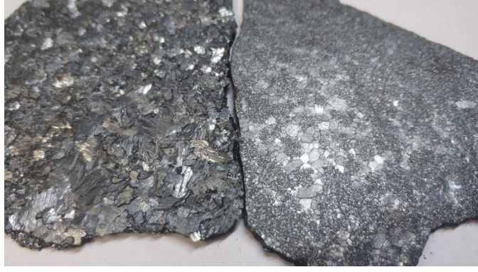
Şekil 4.3. Kütük yüzeyinde oluşan tufal örnekleri.
