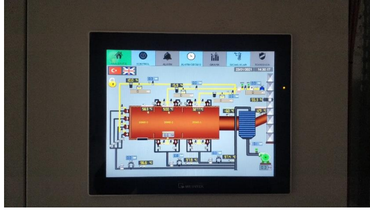
Şekil 3.4. Tav fırını otomasyon sistemi SCADA ekran görünümü.
