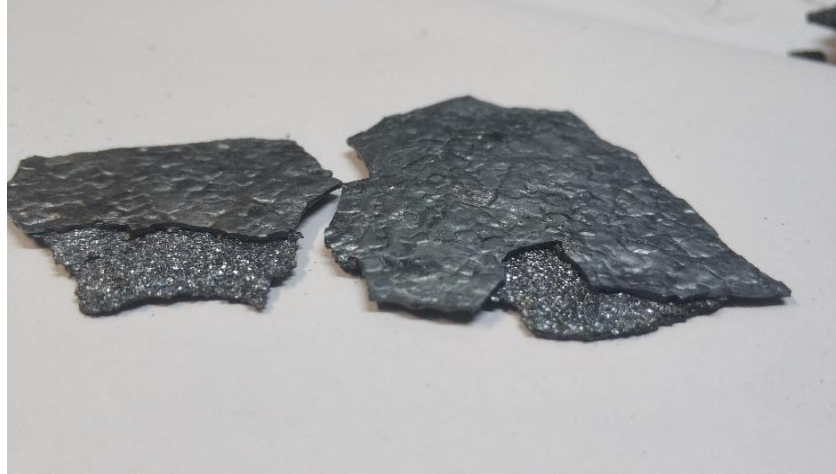
Şekil 4.5. Farklı iki zamanda oluşan tufal katman örneği.
