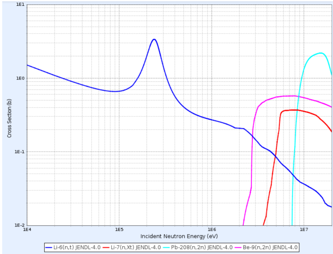
Şekil 4.2. Berilyum (Be) ve Kurşun (Pb) için nötron çoğaltma tesir kesitleri.
