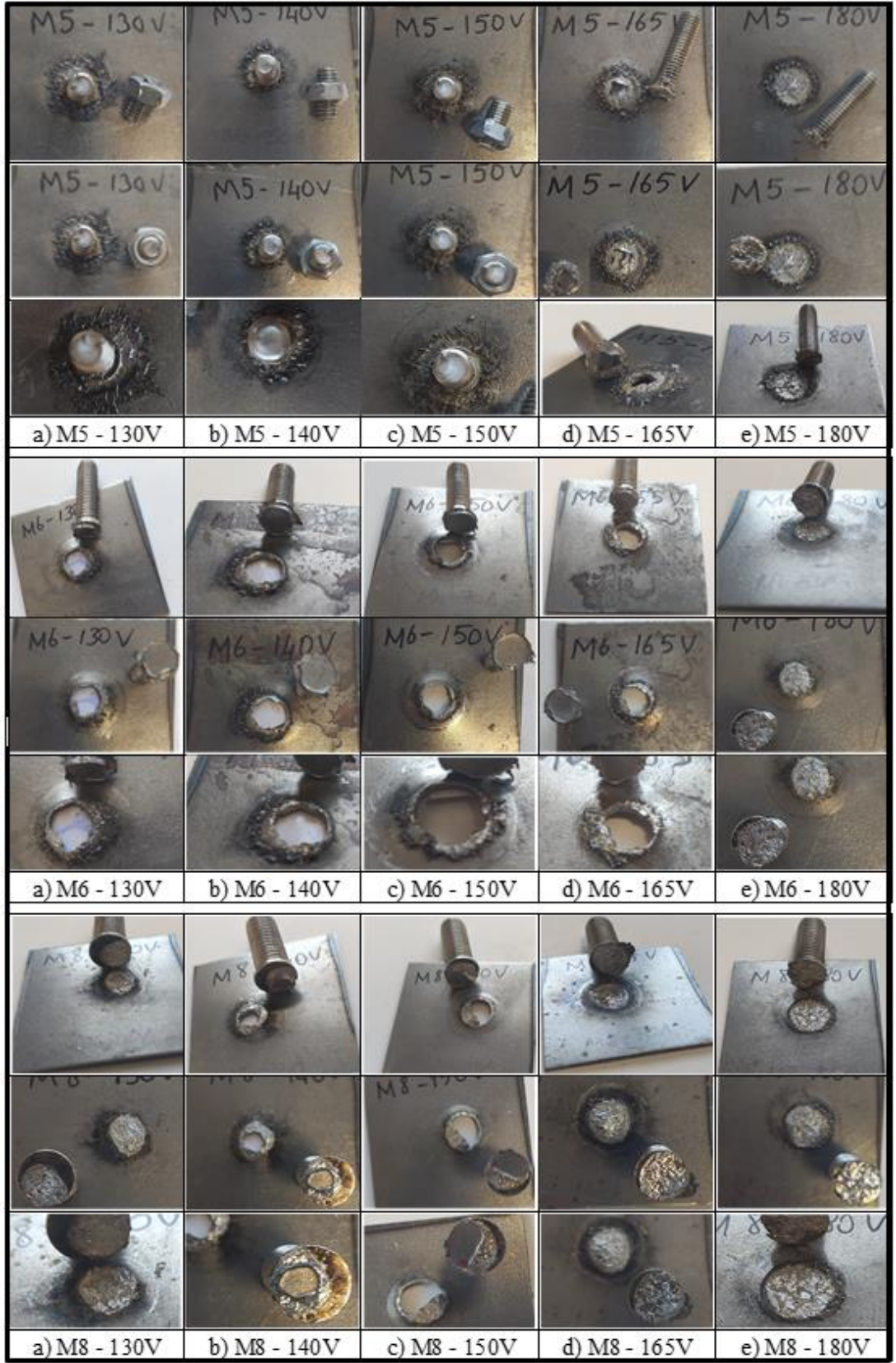
Şekil 6.10. Paslanmaz çelik saplama numunelerin tork testi sonrası görüntüleri.
