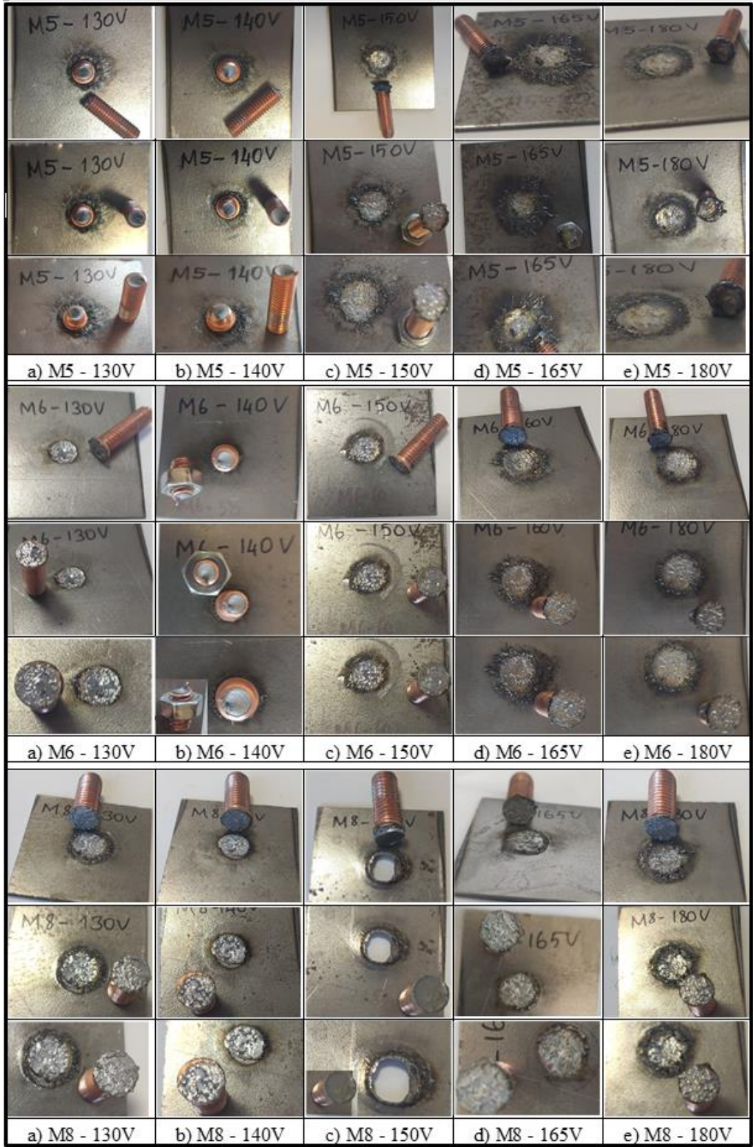
Şekil 6.9. Bakır kaplamalı çelik saplama numunelerinin tork testi sonrası görüntüleri.
