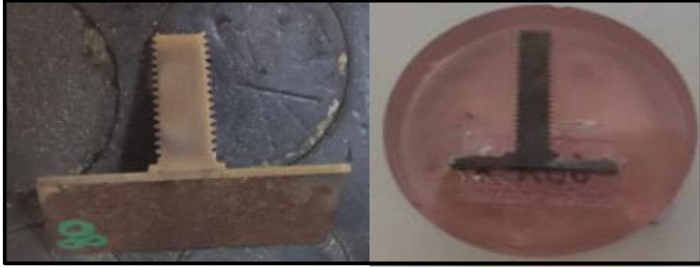
Şekil 5.25. Tel erezyonda kesilmiş numune ve bakalite alınmış görüntüsü.
