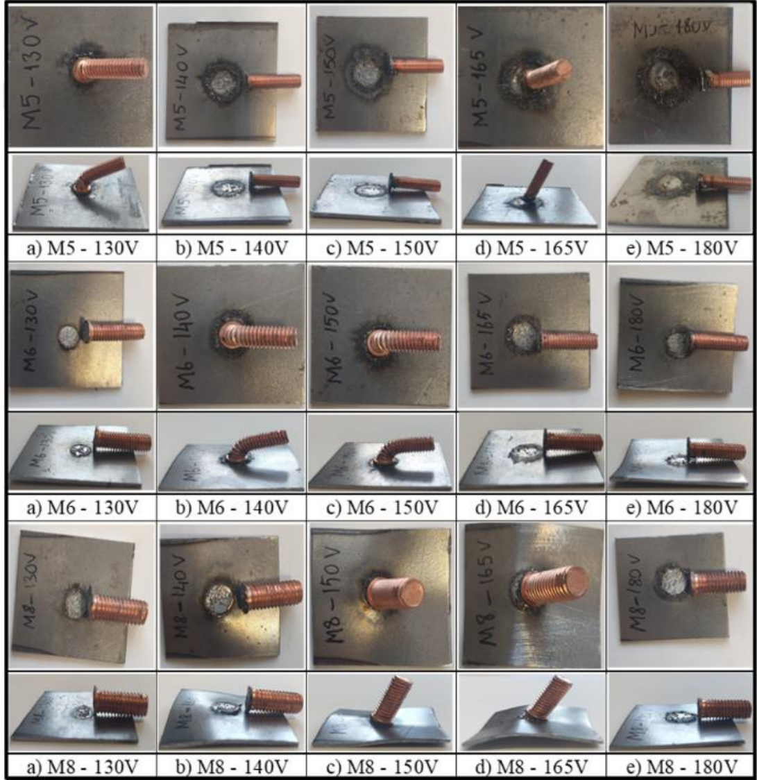
Şekil 6.5. Bakır kaplamalı çelik saplama numunelerin eğme testi sonrası görüntüleri.
