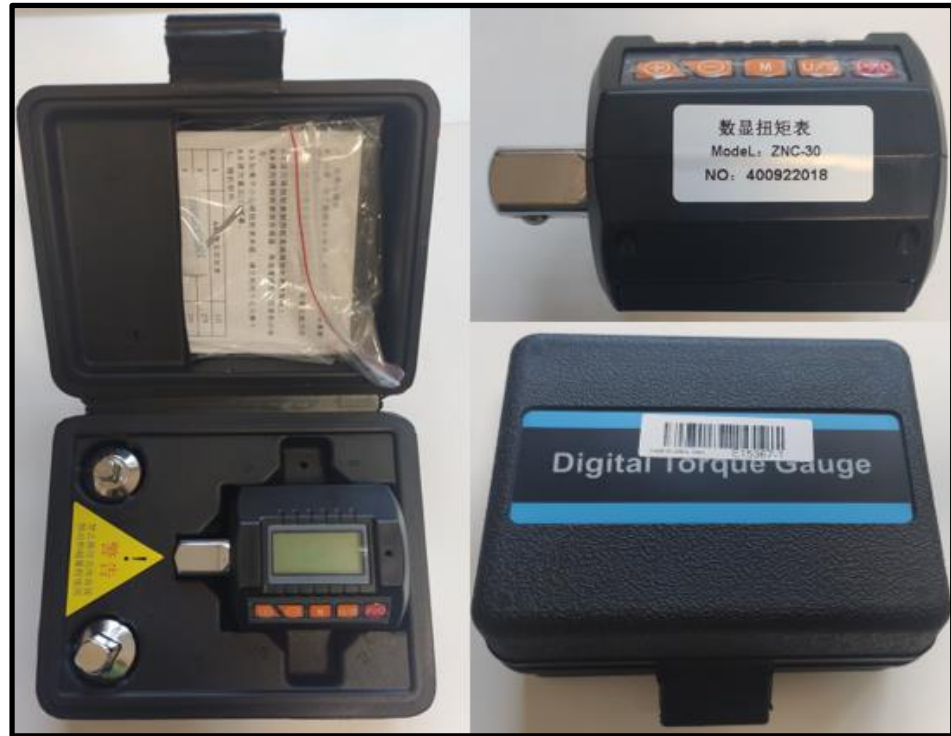
Şekil 5.21. Tork dayanımı ölçümlerinde kullanılan dijital torkmetre.
