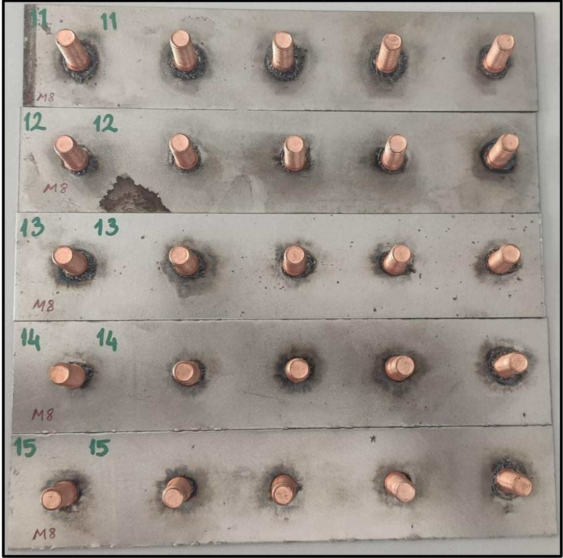
Şekil 5.9. M8 Bakır kaplamalı çelik saplama kaynak numuneleri.
