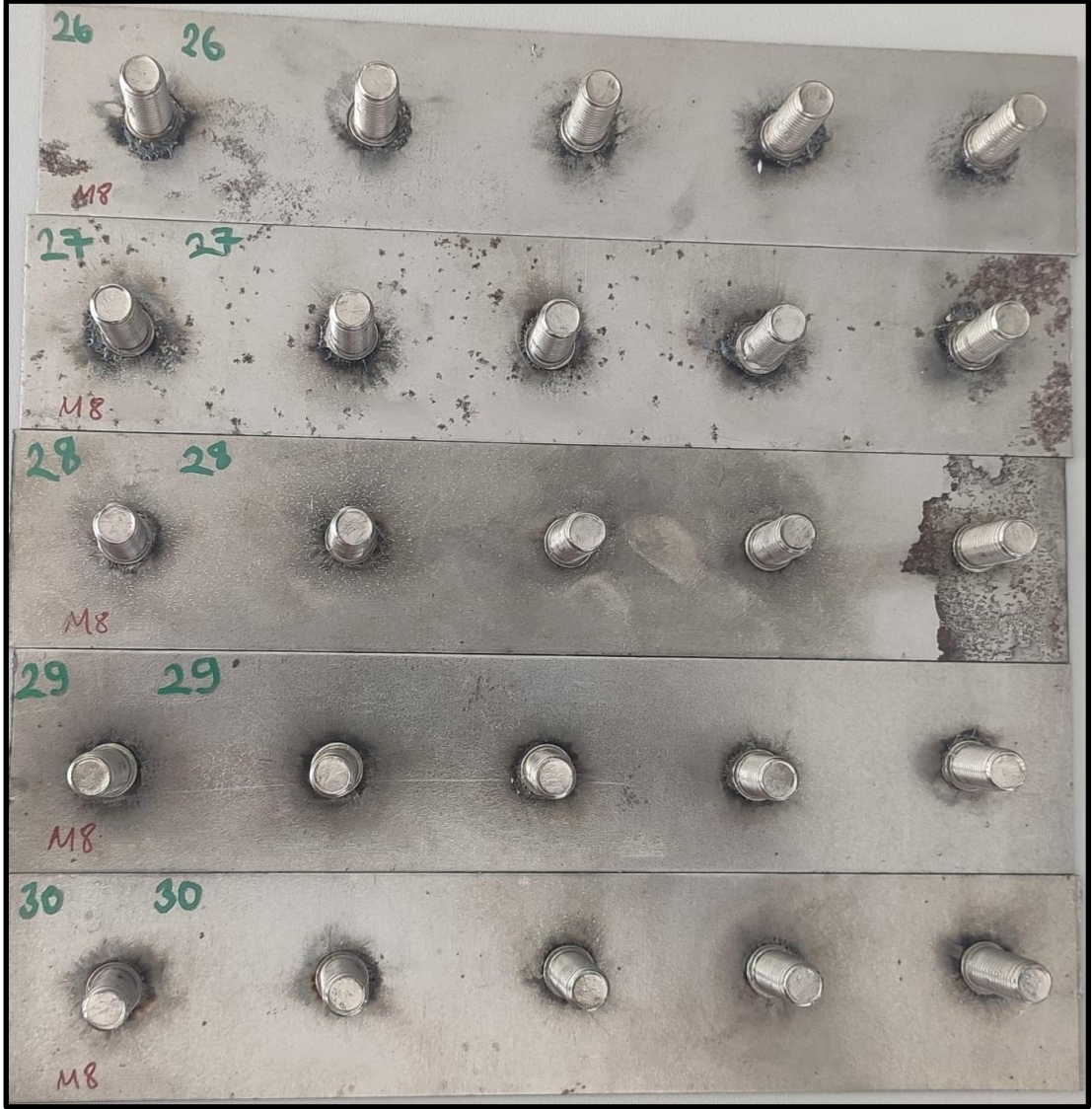
Şekil 5.12. M8 Paslanmaz çelik saplama kaynak numuneleri.
