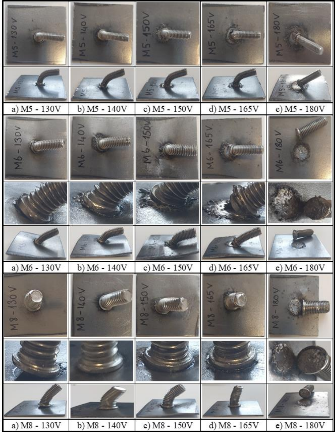
Şekil 6.6. Paslanmaz çelik saplama numunelerin eğme testi sonrası görüntüleri.
