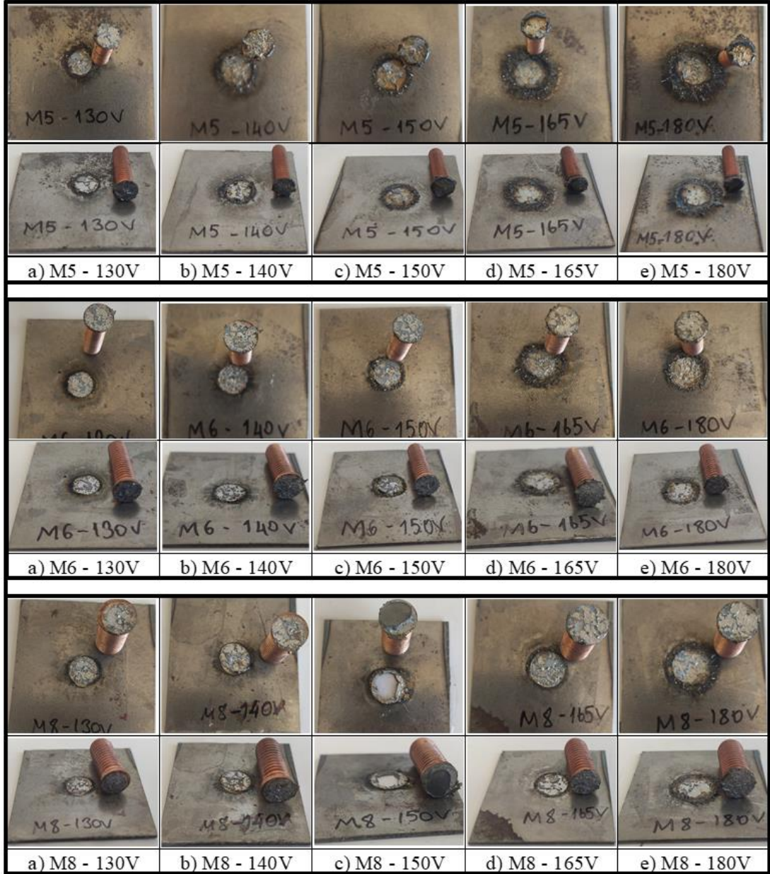
Şekil 6.3. Bakır kaplamalı çelik saplama numelerin çekme testi sonrası görüntüleri.
