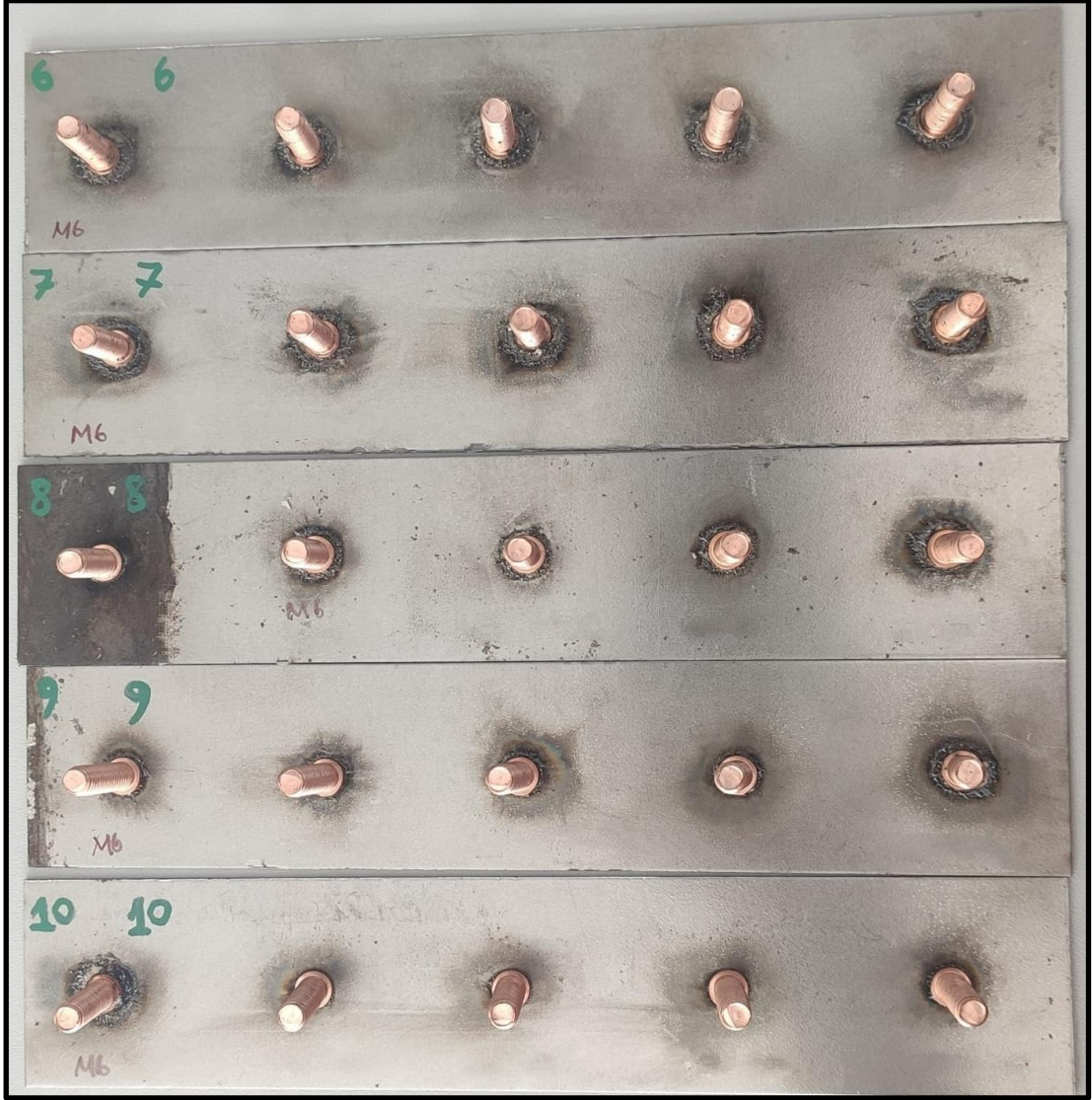
Şekil 5.8. M6 Bakır kaplamalı çelik saplama kaynak numuneleri.
