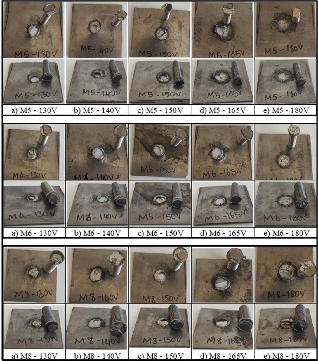
Şekil 6.4. Paslanmaz çelik saplama numelerin çekme testi sonrası görüntüleri.
