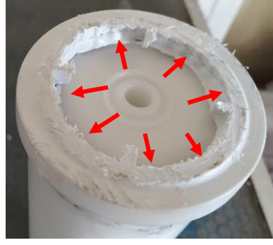
Şekil 3.3. Sediment filtre arızalı eriyik yığılma durumu.
