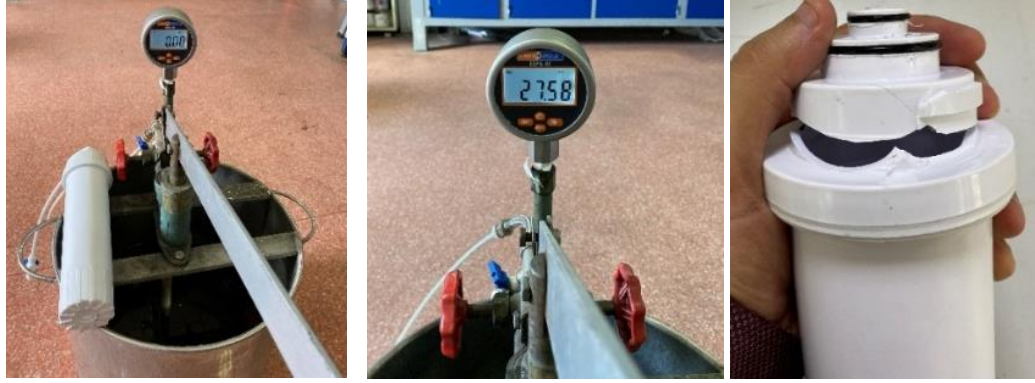
Şekil 6.1. Statik test aparatı ve deney 14'e ait 1 nolu testin maksimum basınç dayanımı.
