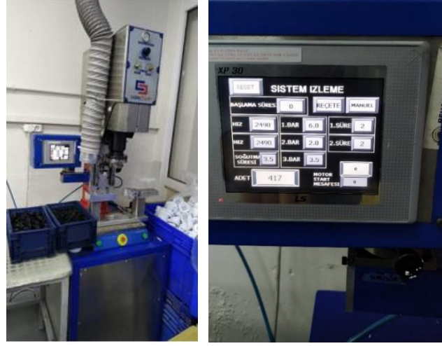
Şekil 5.28. Sürtünme kaynak makinesi ve ekrana girilen parametre.
