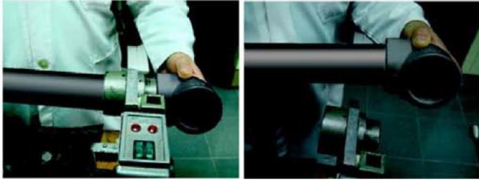
Şekil 2.7. Soket füzyon kaynak tekniğinin uygulanması [25].
