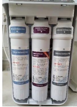
Şekil 3.1. Su arıtma cihazında 5 mikron, aktif karbonun ve 1 mikron filtrenin görünümü.
