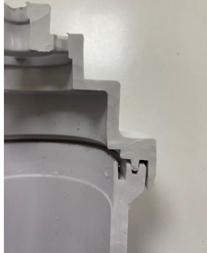
Şekil 5.27. İinline gövde ve kapak parçasının ilk baskısı.
