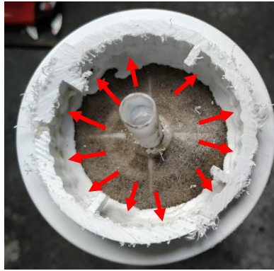
Şekil 3.4. Aktif karbon filtrede eriyik yığılmanın keçenin üzerine akması.
