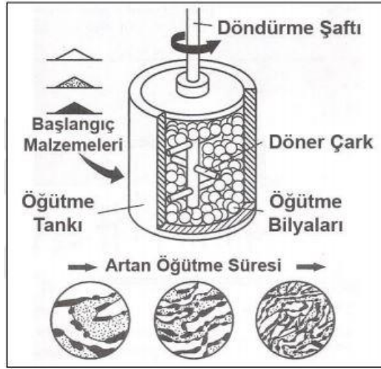
Şekil 2.3. Mekanik alaşımlamanın şematik görünümü [13].
