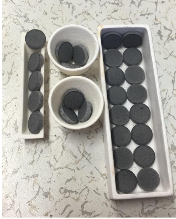
Şekil 4. 7 Kemik tozlarının sıkıştırma işlemi sonrası görünümü.
