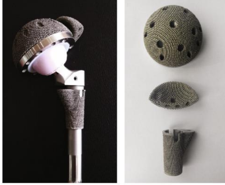
Şekil 2. 3 Ti6Al4V alaşımlı implant [17].
