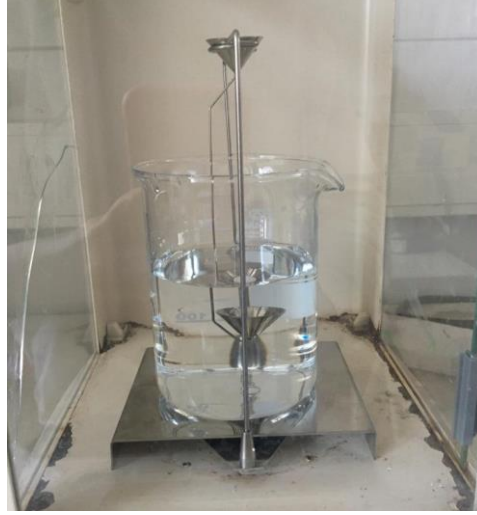
Şekil 4. 10 Arşimet ilkesi düzeneği.
