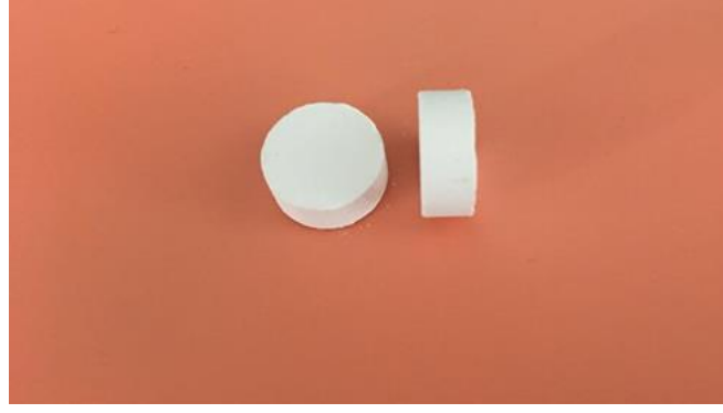
Şekil 4. 8 Kemik tozlarından sinterlenerek elde edilmiş diskler.
