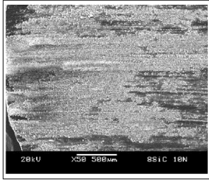
Şekil 4.7. Oksidatif aşınmaya uğramış yüzey görüntüsü [45].
