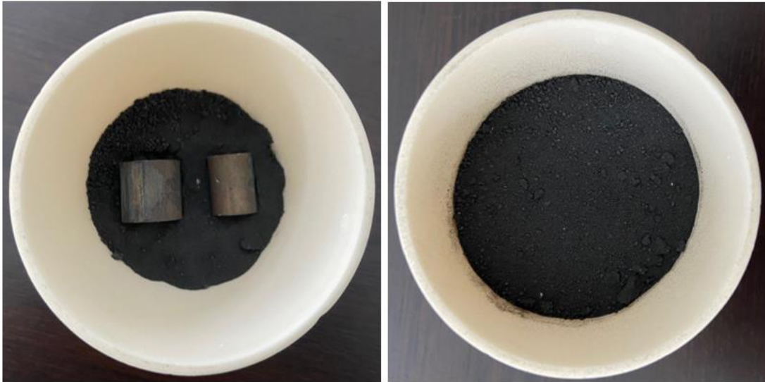
Şekil 6. 4. Numunelerin seramik pota içerisine yerleşimi ve üzerinin toz ile kapanması.
