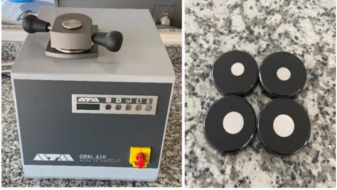
Şekil 6. 8. Bakalite alma cihazı ve hazırlanan bakalitler.
