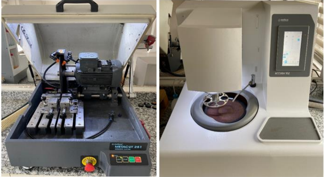
Şekil 6. 2. Numune kesme ve parlatma cihazı.
