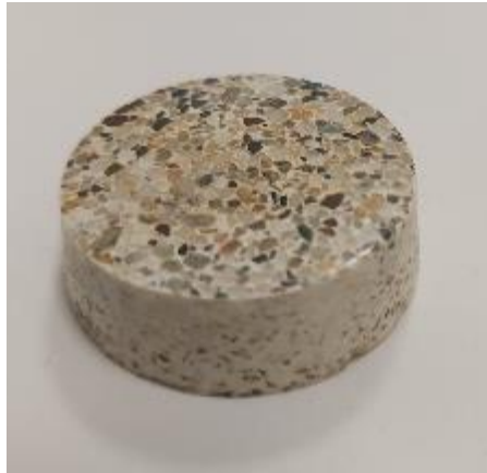
Şekil 5.17. Alkali aktive cam tozu ve renkli kum dolgusu ile üretilen terrazzo numunesi.
