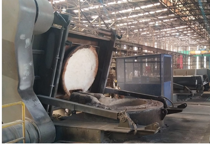
Şekil 4.1. Ergitme için kullanılan indüksiyon ocağı.
