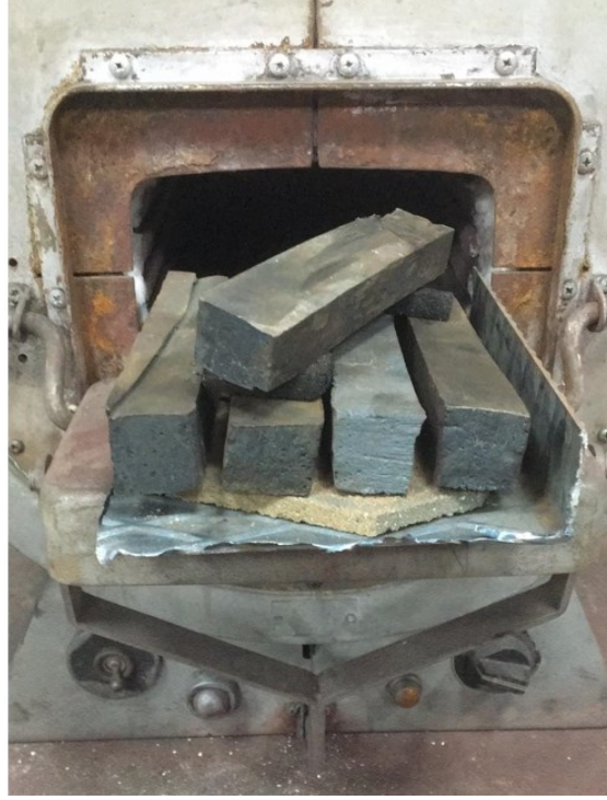
Şekil 4.4. Numunelerin ısıtım işlem fırınına yerleştirilme şekli.
