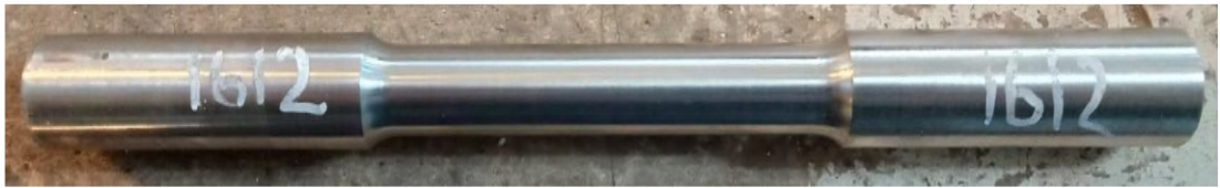
Şekil 4.7. Akma-çekme testi için hazırlanan numunenin görseli.
