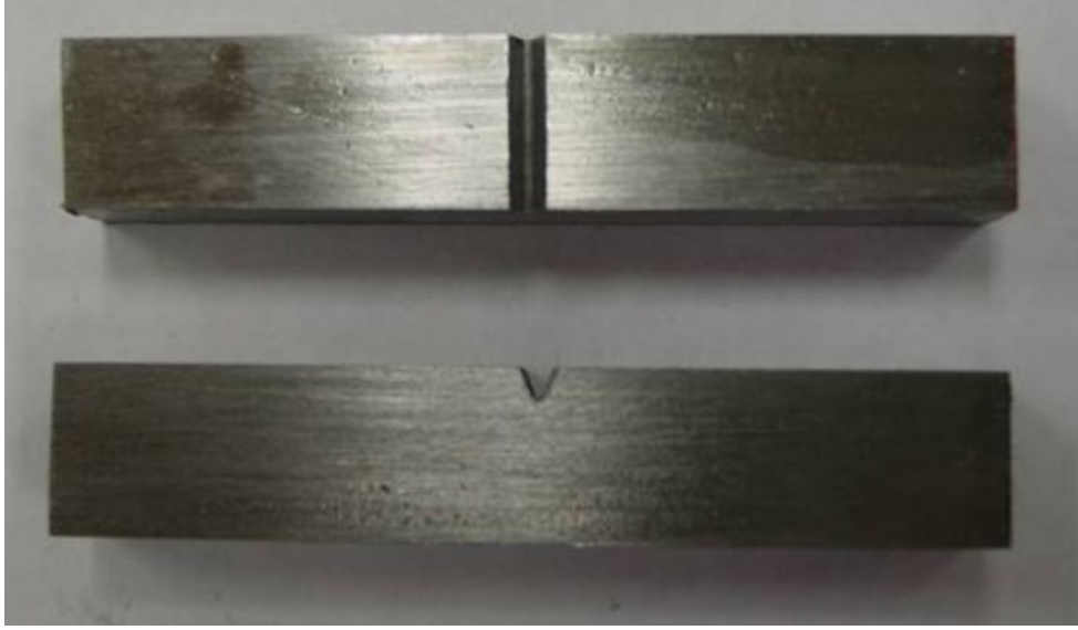
Şekil 4.11. Çentik-darbe testi için hazırlanan numunenin görseli.
