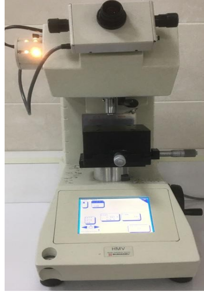
Şekil 4.16. Shimadzu Marka Hmv model sertlik ölçme cihazı.
