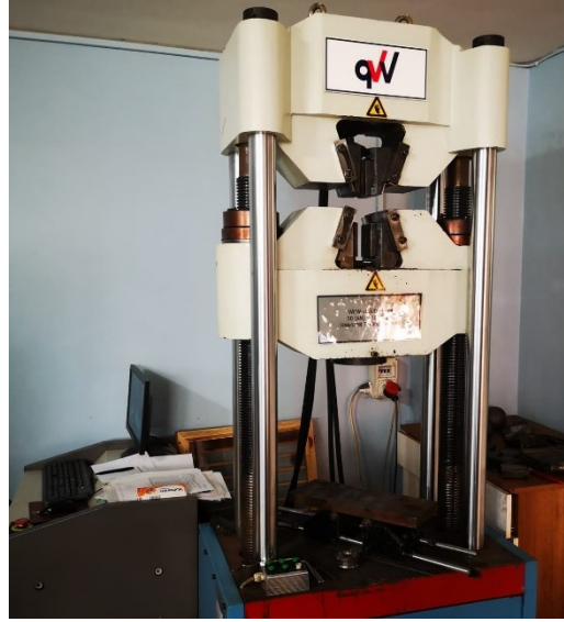
Şekil 4.8. Deneysel çalışmalarda kullanılan WEW1000D Model çekme testi cihazı
