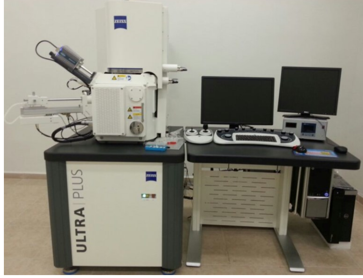
Şekil 4.15. Deneysel çalışmalarda kullanılan CARL ZEISS ULTRA PLUS GEMINI FESEM marka taramalı elektron mikroskobu.
