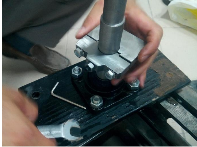
Şekil 2.20. Eksantrik kütlelerin montajına ait bir görüntü.
