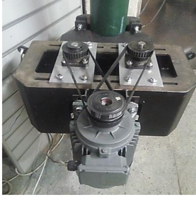
Şekil 2.32. Çift eksantrik kütleli paralel eksenli 235 mm açıklıklı deneylere ait bir fotoğraf.
