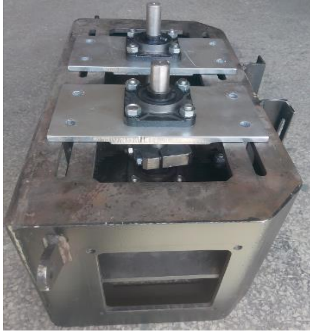
Şekil 2.22. Sarsıcı gövdesi, eksantrik kütleler ve hareket mekanizmalarının montaj edilmiş hâline ait bir görüntü.
