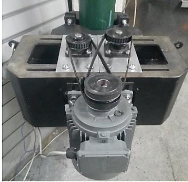
Şekil 2.31. Çift eksantrik kütleli paralel eksenli 140 mm açıklıklı deneylere ait bir fotoğraf.
