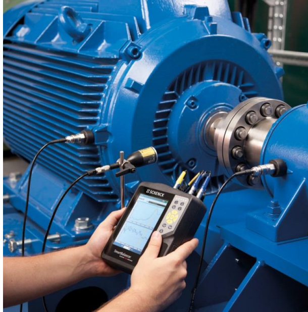
Şekil 1.17. Titreşim ölçüm ve analiz cihazı ile titreşim ölçümüne ait görüntü [43].
