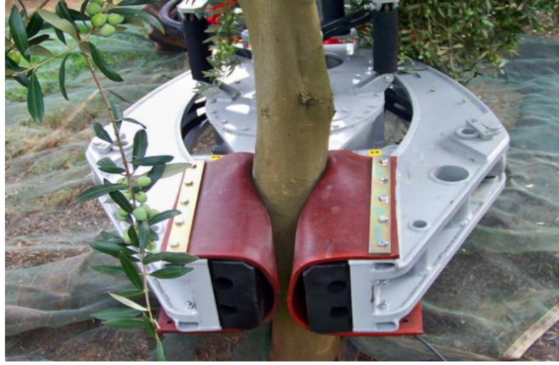
Şekil 1.7. Sarsıcının ağaç gövdesini sıkmasına ait bir görüntü [17].
