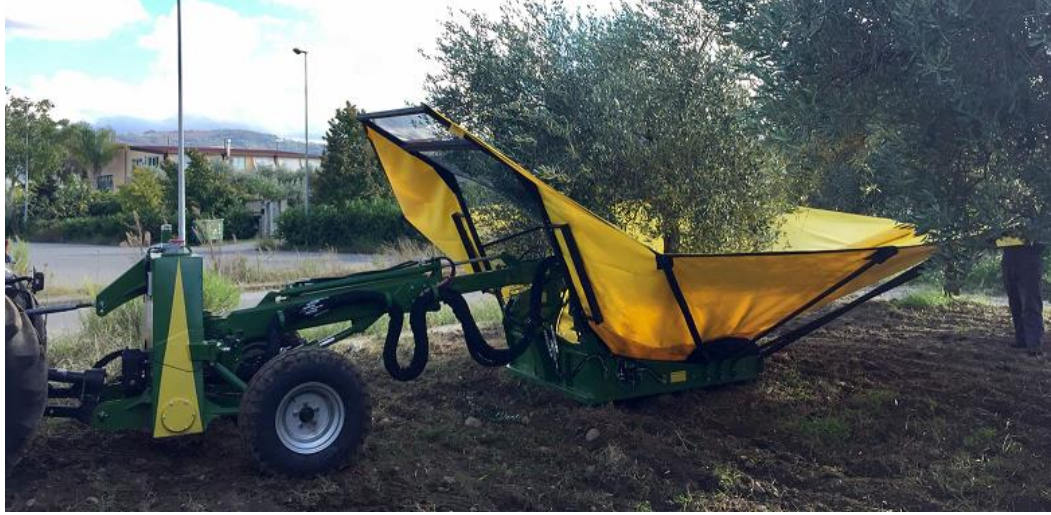
Şekil 1.9. Brandalı toplayıcı sisteme sahip bir gövde sarsıcı ile hasat [20].
