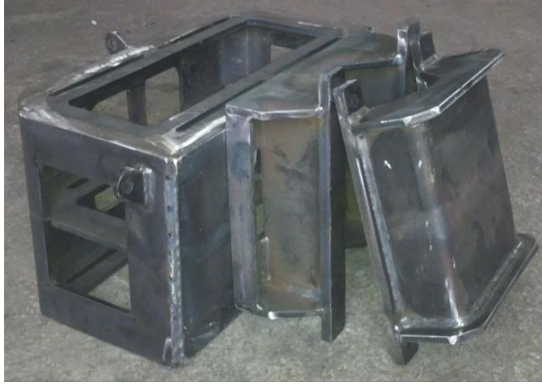
Şekil 2.19. Gövde sarsıcının ana gövdesinin ve kelepçesinin kaynaklı birleştirilmiş hâline ait bir görüntü.
