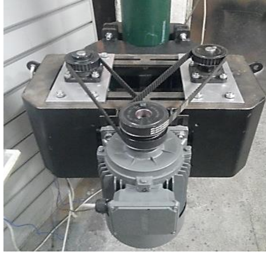
Şekil 2.33. Çift eksantrik kütleli paralel eksenli 320 mm açıklıklı deneylere ait fotoğraf.
