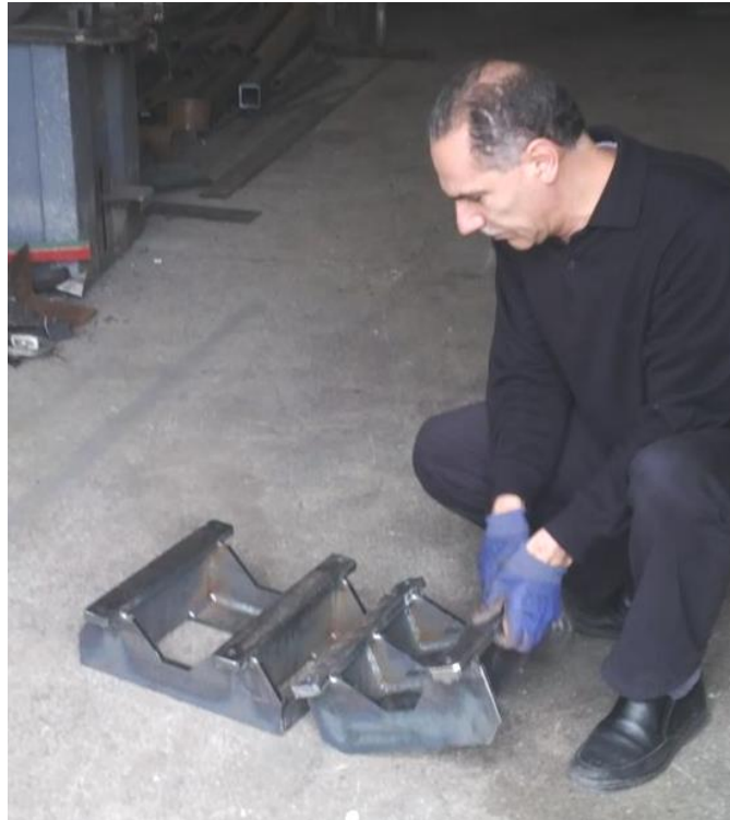
Şekil 2.18. Gövde sarsıcının kelepçesine ait montaj işlemine ait bir görüntü.
