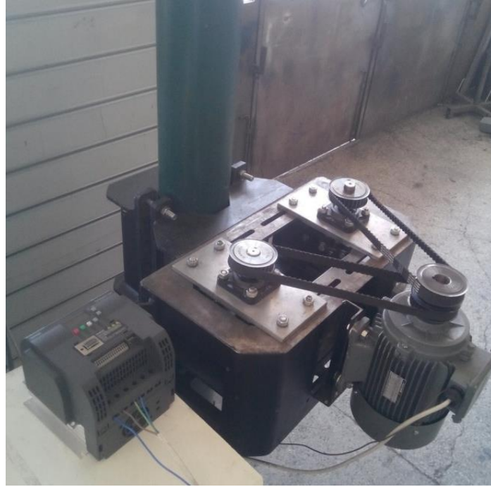
Şekil 2.24. Sarsıcı gövdenin ağaç direğe bağlanmış, denemelere hazır hâline ait bir görüntü.
