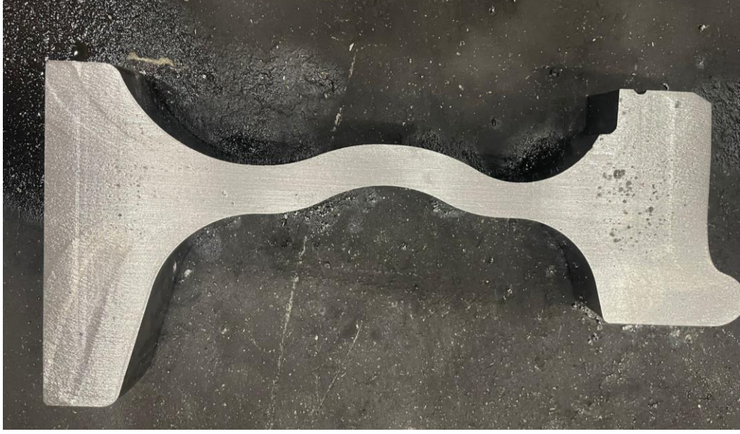
Şekil 4.1. Tekerden kesilen kesit parçası
