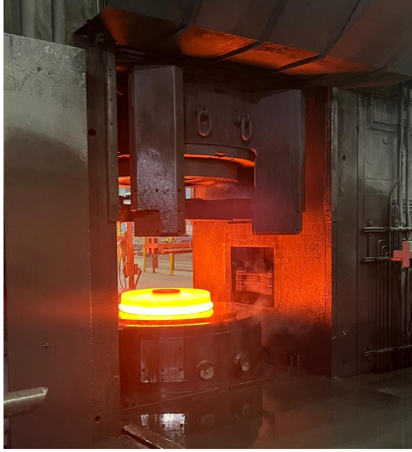
Şekil 2.5. 10bin ton preste ön şekillendirme prosesi
