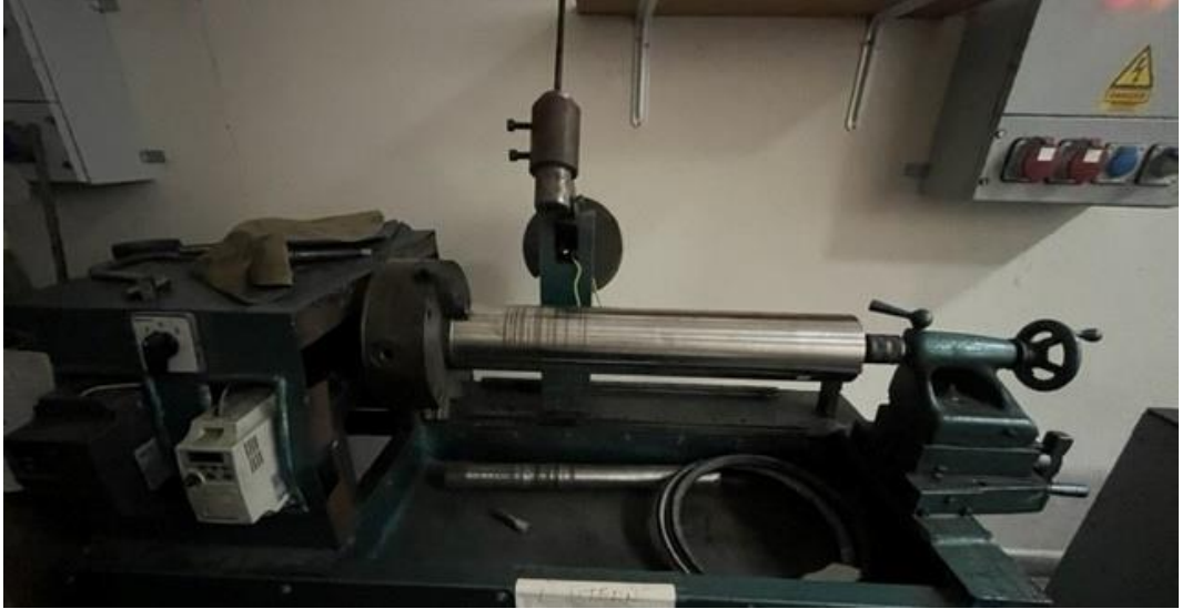
Şekil 4.4. Aşınma testi mekanizması
