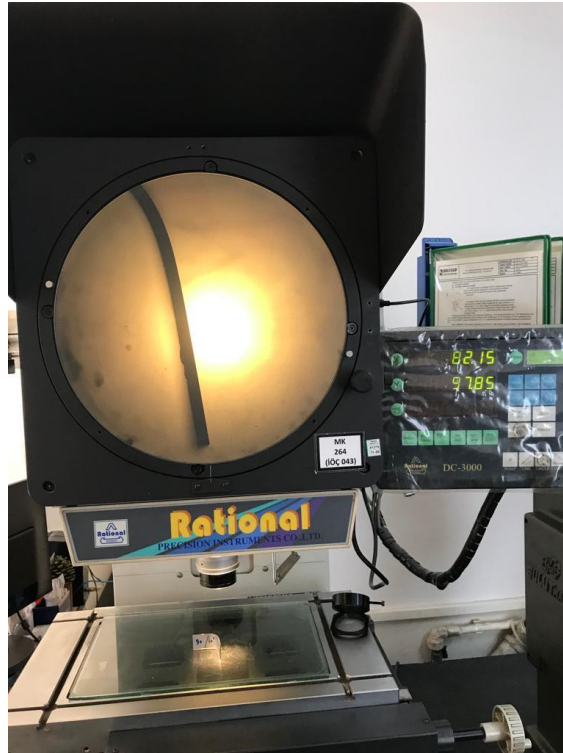
Şekil 6.18. Lazer optik projeksiyon cihazında geri yaylanmanın ölçümü.
