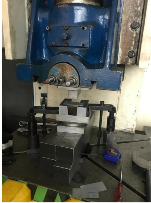
Şekil 6.12. Kalıbın adaptör parça ile prese bağlanması.
