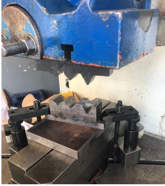
Şekil 6.15. Kalıbın adaptör parça ile prese bağlanması.
