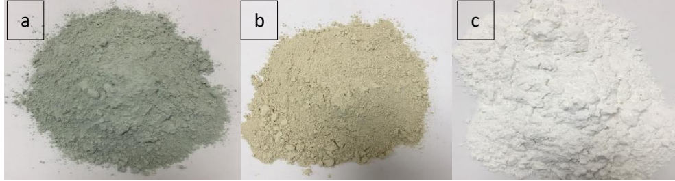
Şekil 3.1. AAM hazırlığında kullanılan toz malzemeler: a) Yeşil bayburt tüfü, b) Beyaz Bayburt Tüfü, c) Mikronize Kalsit.
