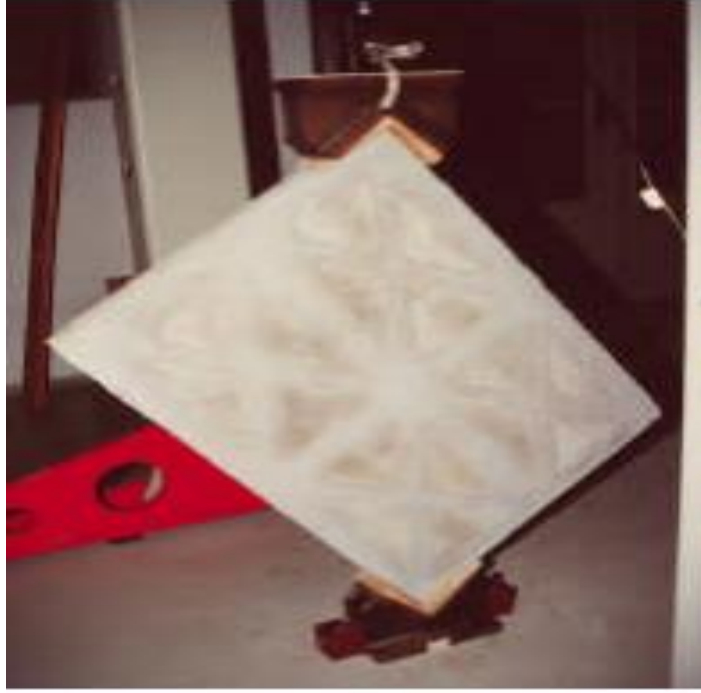
Şekil 4.15. Doğrulama panelinin kuvvet altında görünümü [43].
