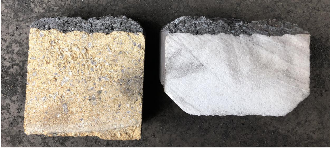
Şekil 4.2. Seramik kaynak uygulanmış şamot ve modül tuğla.
