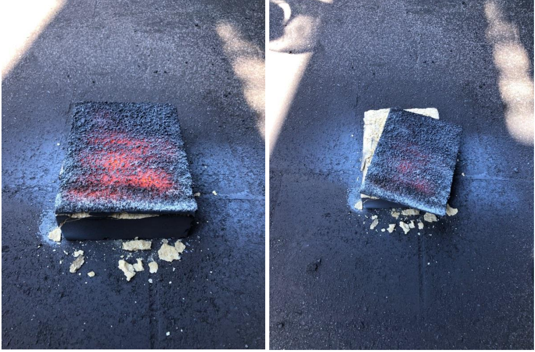
Şekil 4.3. Seramik kaynak uygulanmış silika tuğla.
