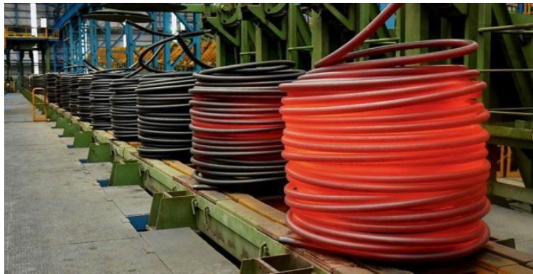
Şekil 2.1. Kangal Üretim Tesisi-Yarı Mamül Sarım şeklindeki kangalın ilk görüntüsü.
