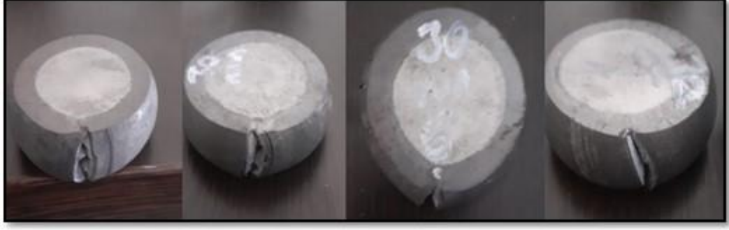
Şekil 4.21. 30MnB4 kalite kangallarda basma testi sonrası meydana gelen hasarlar.
