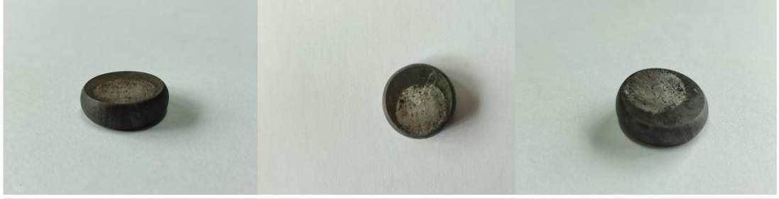
Şekil 4. 20. 27MnB4 kalite kangallarda basma testi numuneleri.
