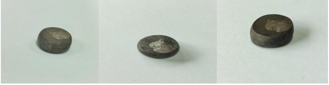
Şekil 4.19. 23MnB4 kalite kangallarda basma testi numuneleri.
