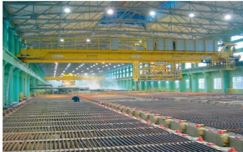
Şekil 3. 8. Çin'de modern bir bakır elektrorefinasyon tesisi.
