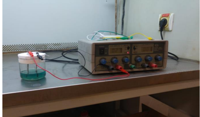
Şekil 4. 13. Hazırlanan elektrokazanım hücre denemelerinden biri.
