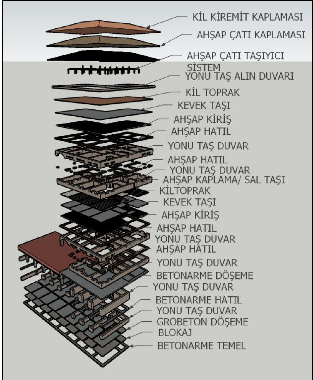
Şekil 5.75. Besici ve çiftçi evleri yapım sistemi.
