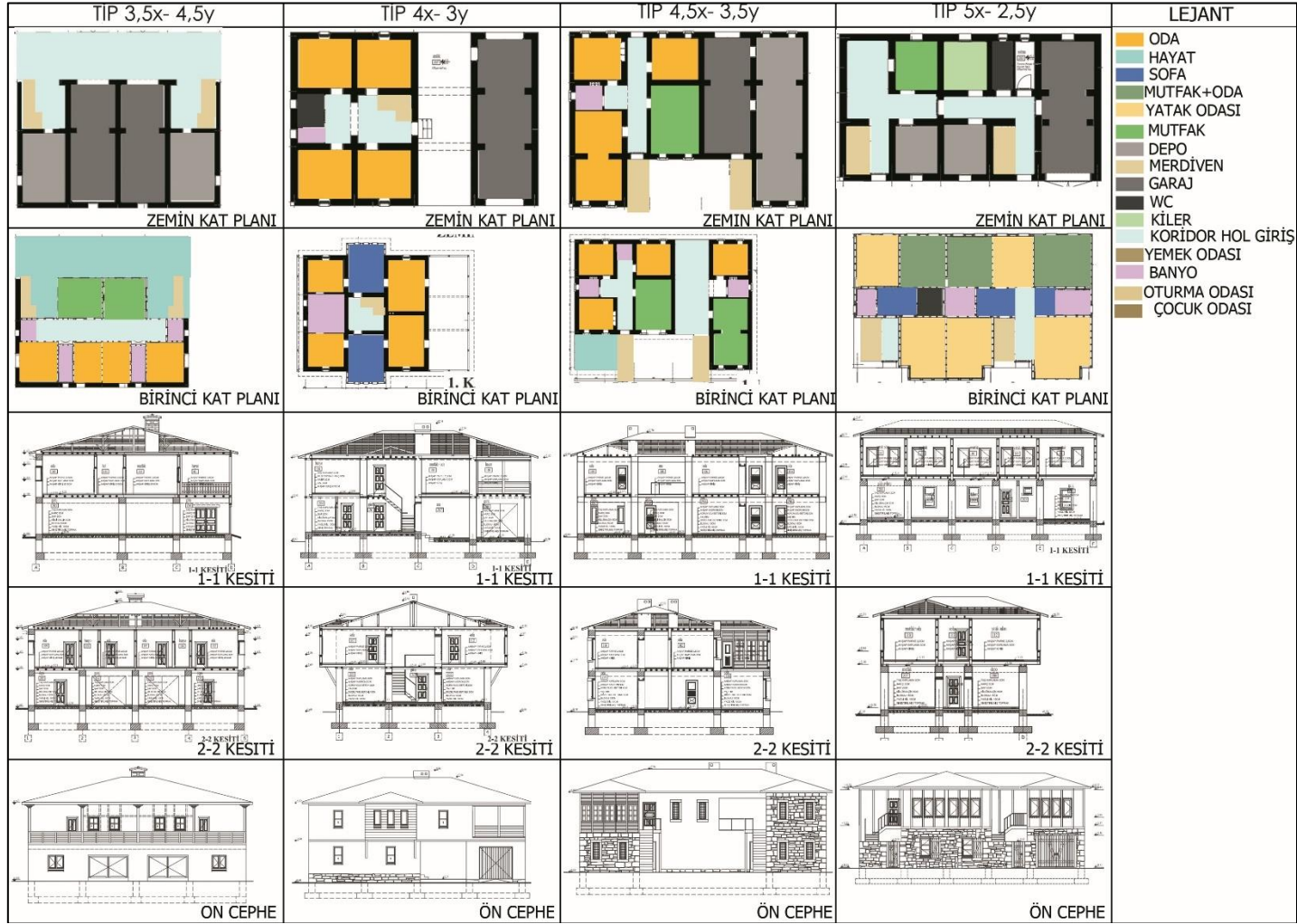
Şekil 2.5. Balıkesir öneri köy konutları kat planı kesit cepheleri 2 [78].
