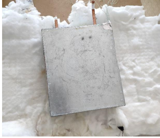
Şekil 5.11. Parafin ve çelik sünger destekli ısı eşanjörü ve seramik yünü.
