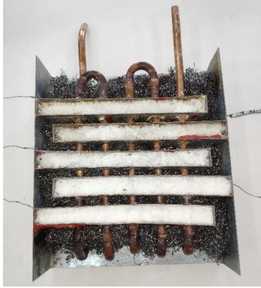
Şekil 5.10. Çelik süngerin ısı eşanjörüne olan montajı.
