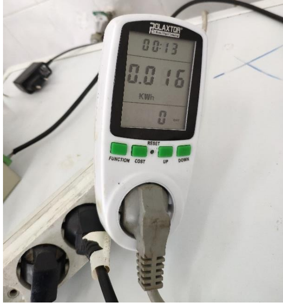
Şekil 5.16. Polaxtor dijital wattmetre.
