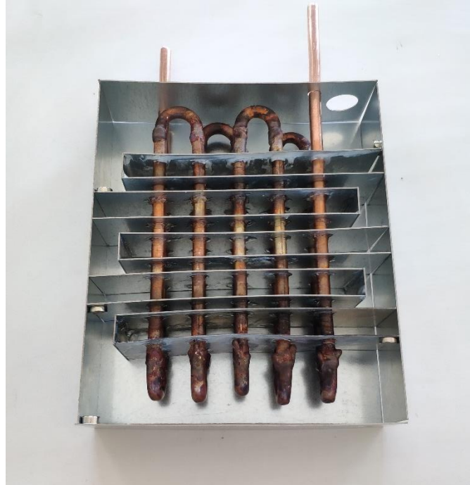
řekil 5.5. Hücreslerin ve bakır borunun gövdeye olan montajı.
