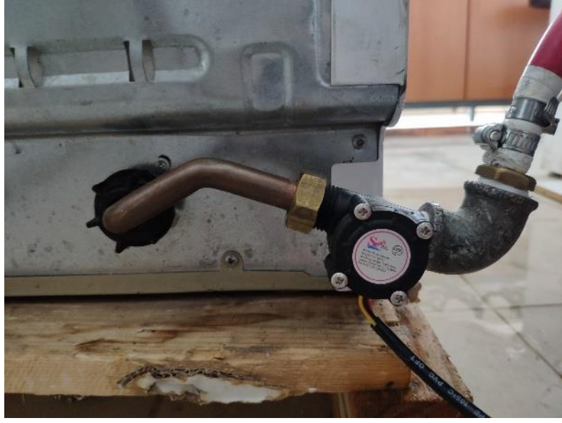
Şekil 5.14. YF-S201 su akış sensörünün bulaşık makinesi şebeke suyu giriş bağlantısı.
