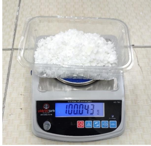
Şekil 5.7. Her bir hücrede bulunan 100 g talaş halindeki parafin.
