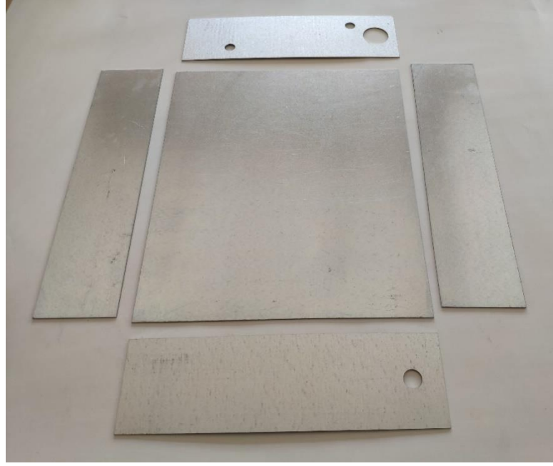
Şekil 5.3. Parafin ve çelik sünger destekli ısı eşanjörünün gövde plakaları.
