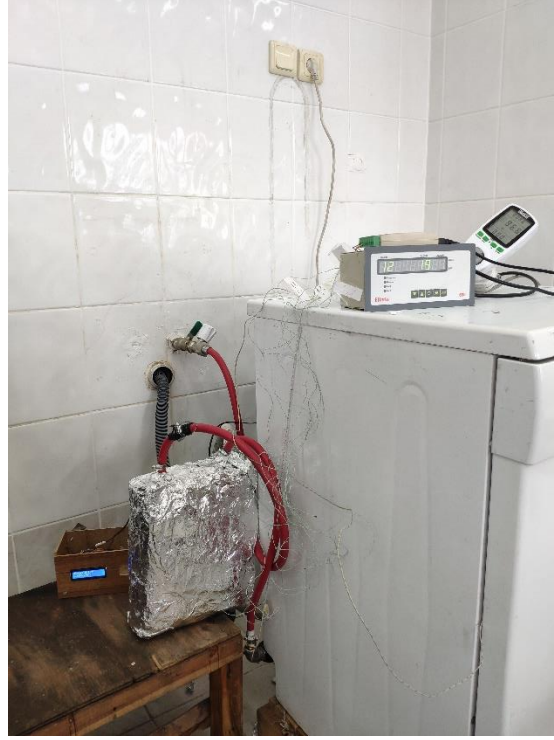
Şekil 5.13. Parafin ve çelik sünger destekli ısı eşanjörünün ve ölçüm cihazlarının bulaşık makinesine olan montajı.
