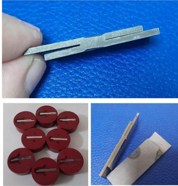
Şekil 5.13. Zımparalanmış ve bakalite alınmış test numuneleri.
