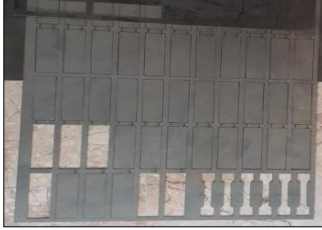
řekil 5.1. Lazer kesimi yapılan levhalar.
