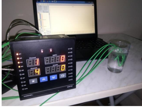
Şekil 4.5. Deney düzeneği sıcaklık ölçme sistemi kalibrasyonu.
