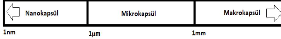
Şekil 3.25. FDM kapsül sınır boyutlarının şematik gösterimi [54].
