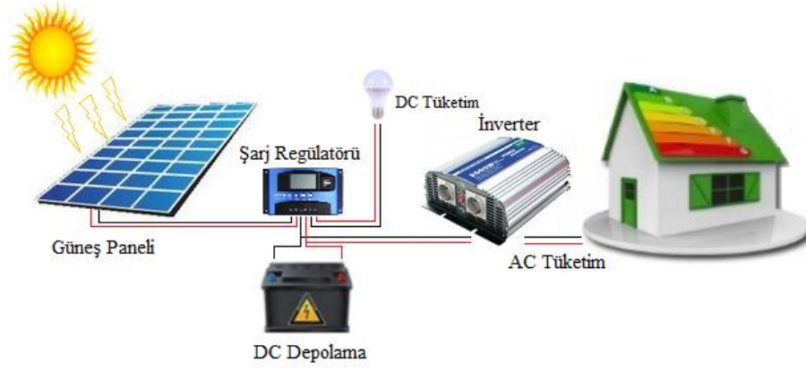
Şekil 3.15. Şebekeden bağımsız sistemlerin akış şeması [36].
