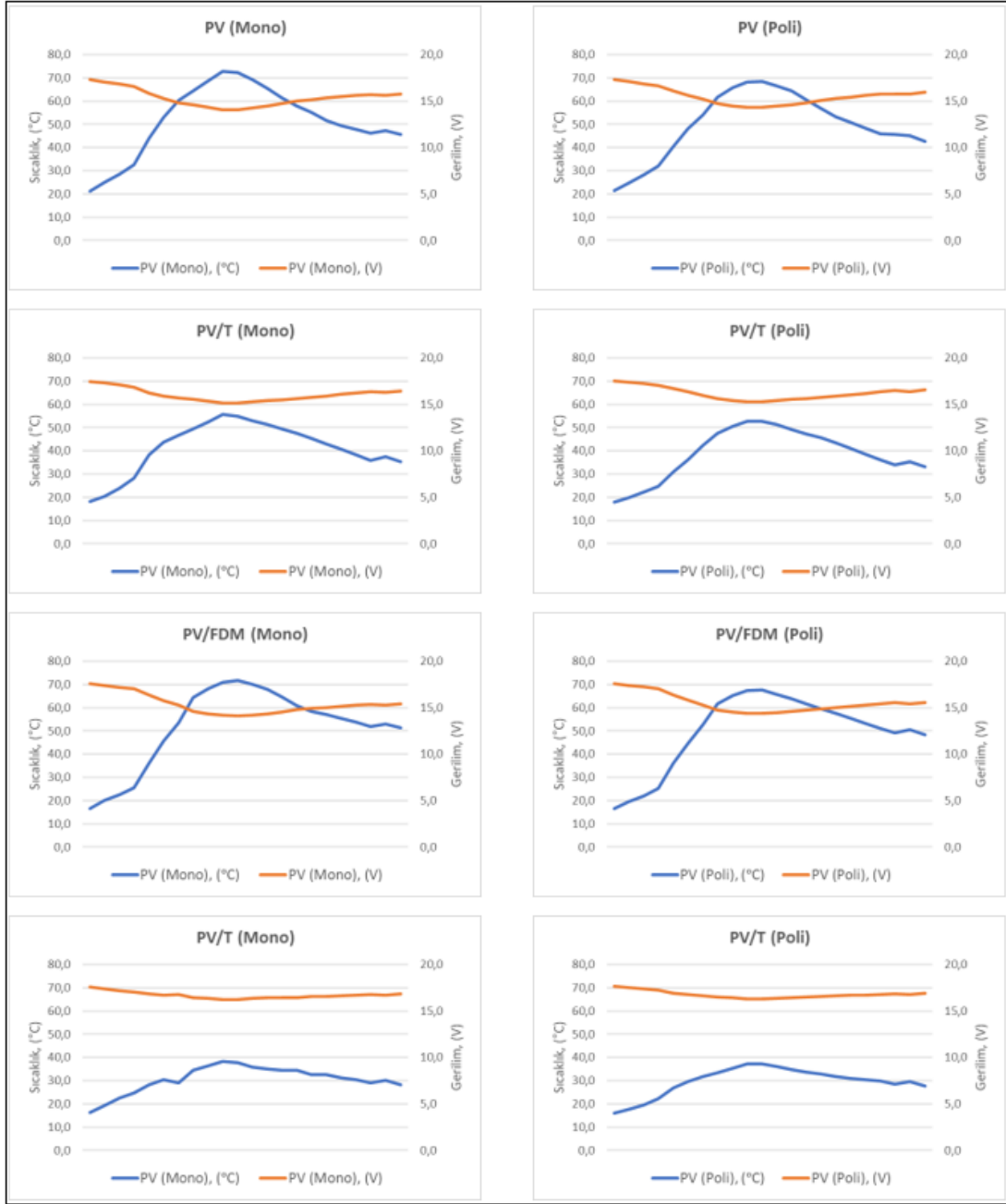
Şekil Ek A. 3. Modüllerde Sıcaklığa Bağlı Gerilim Değişimi, (19.08.2022)
