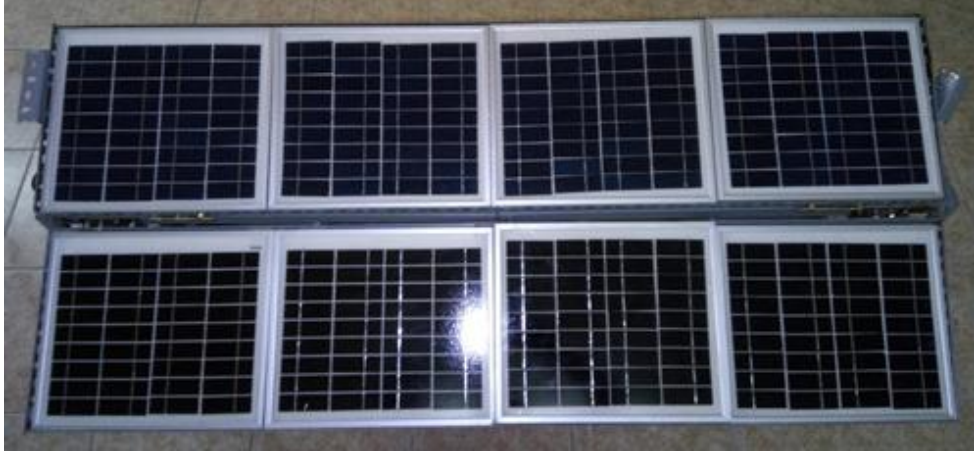
Şekil 4.7. PV modüllerin kasetlere yerleştirilmesi.
