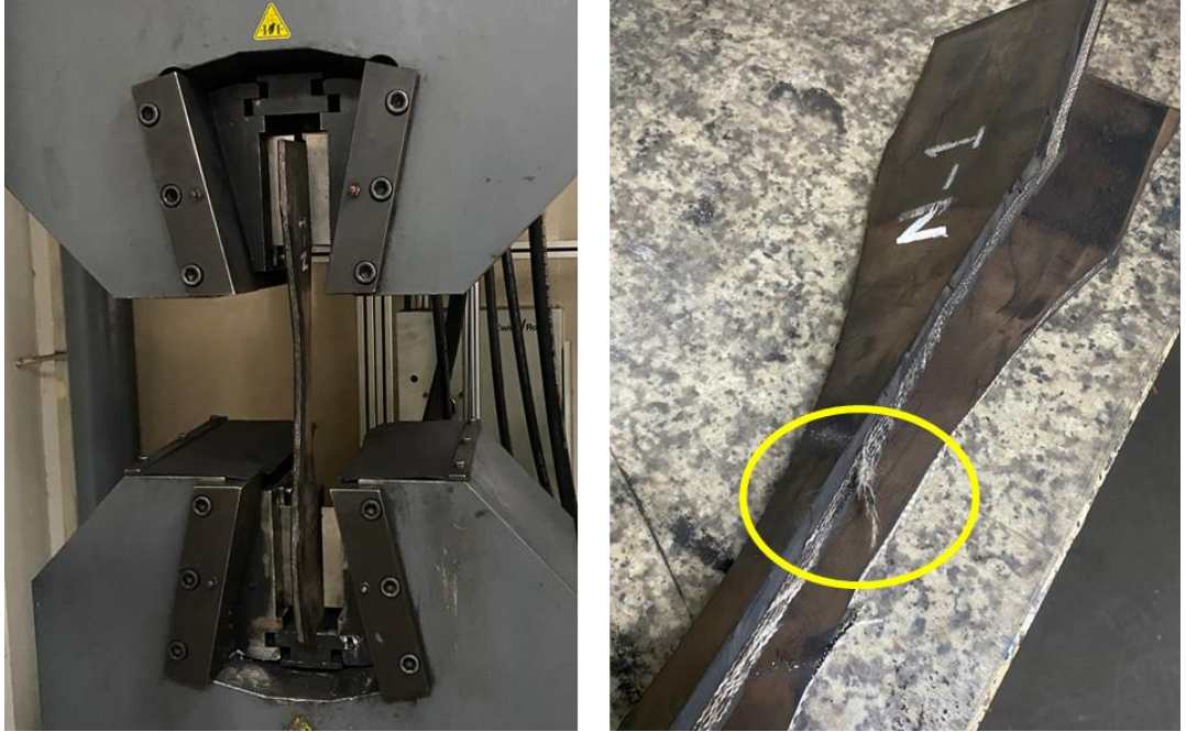
Şekil 6.2. N-1 no'lu numunenin çekme deneyi sonrası kopması.
