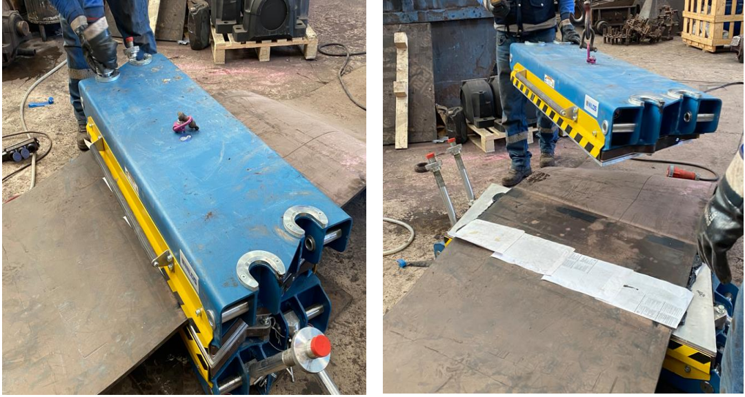
Şekil 3.46. Kaynak makinesinin sökülmesi
