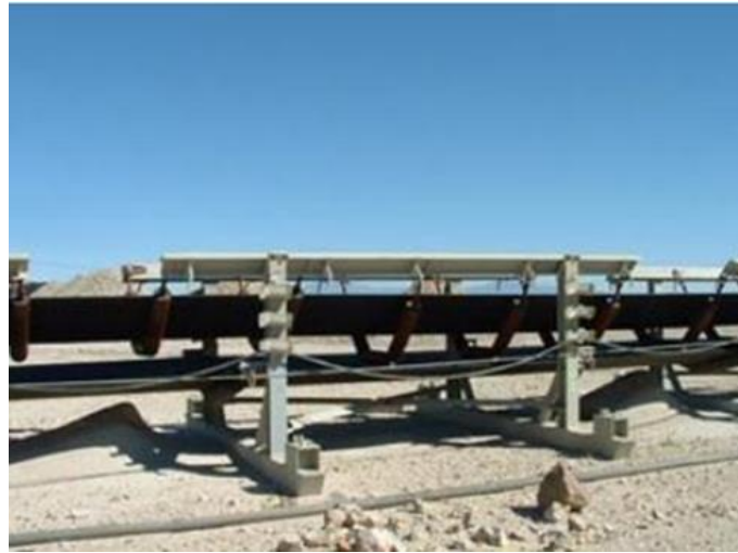
Şekil 2.6. Thyssenkrupp firmasına ait kayabilen bantlı konveyör [7].
