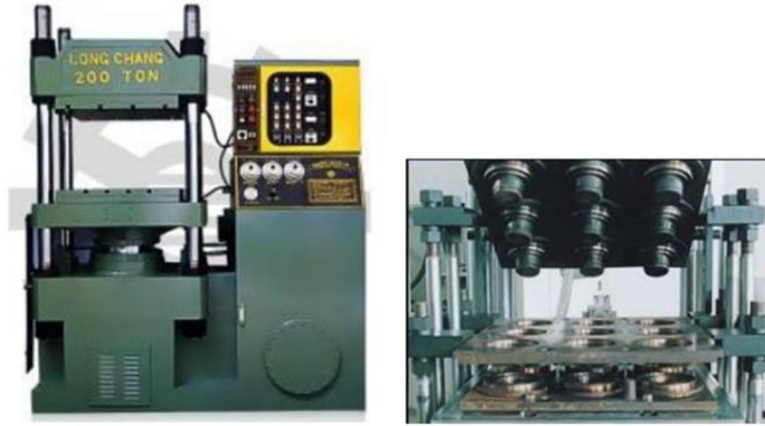
Şekil 3.11. Kompresyon pres ve kalıp düzeneği [11].
