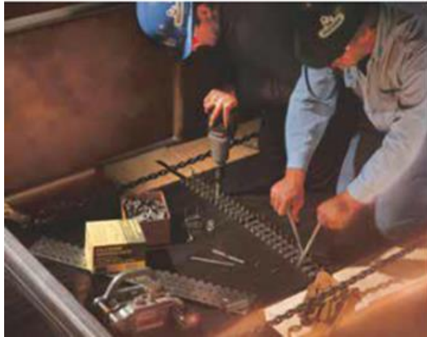
Şekil 3.4. Konveyör bantların mekanik ekler ile birleştirilmesi [10].
