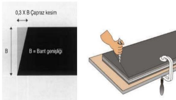
Şekil 3.19. Konveyör bandın çapraz kesim işlemi [13].
