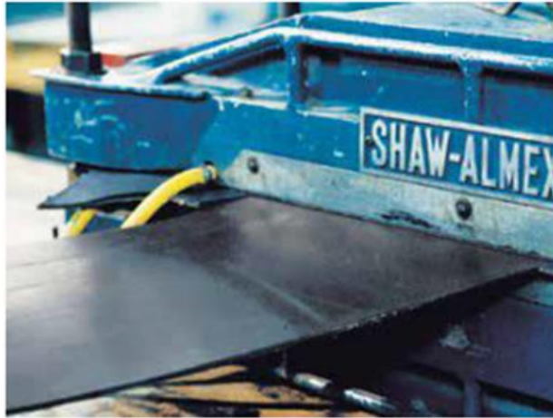
Şekil 3.1. Pres kullanılarak sıcak vulkanizasyon ile ekleme yapılan konveyör bandı [9].
