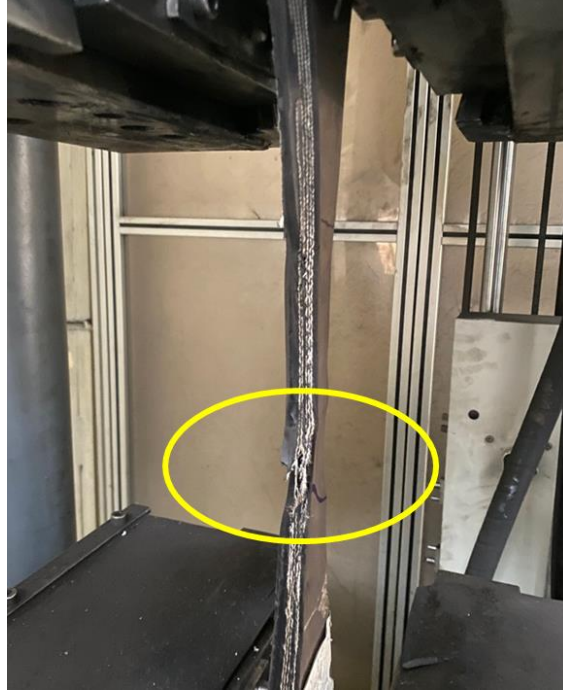
Şekil 6.8. S-45-2 no'lu numunenin çekme deneyi sonrası kopması
