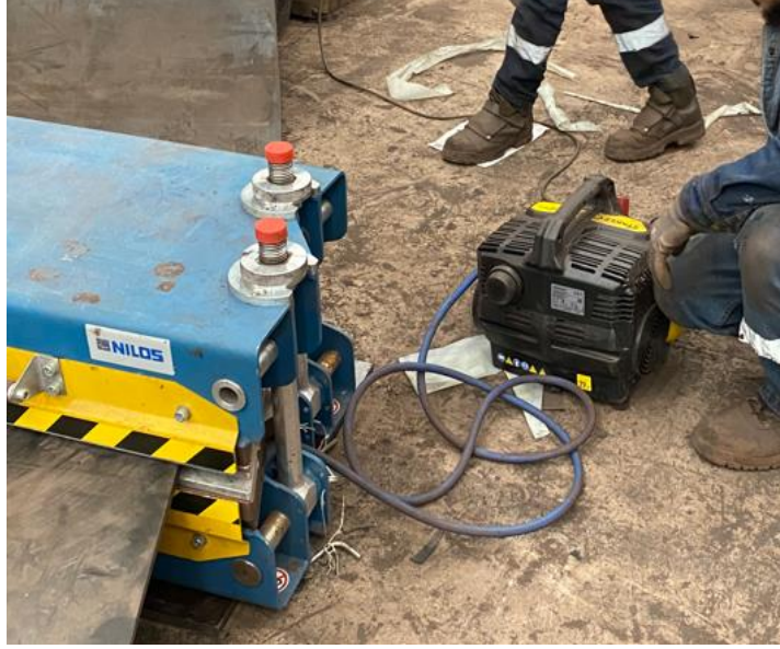
Şekil 3.42. Elektrik pompası bağlantısı
