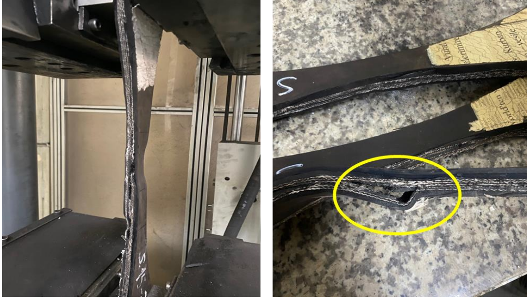
Şekil 6.4. S-15-3 no'lu numunenin çekme deneyi sonrası kopması
