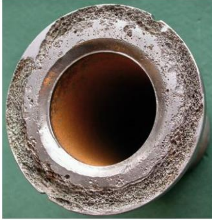
Şekil 3.8. Malzeme yüzeyinde oluşan aralık korozyonu görüntüsü [86].
