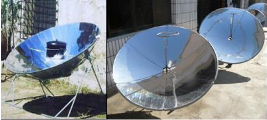
Şekil 3.11. İçbükey ısıtıcı sistem görüntüsü ( http://powersolar.com.tr , 2022).
