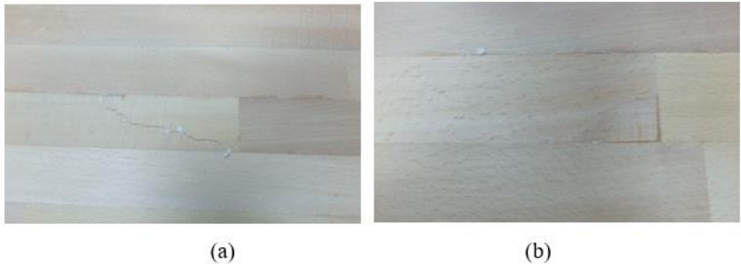
Şekil 2.7. Masif panelde sorunlu yüzey tipleri a) Pürüzlü b) Çukur içeren
