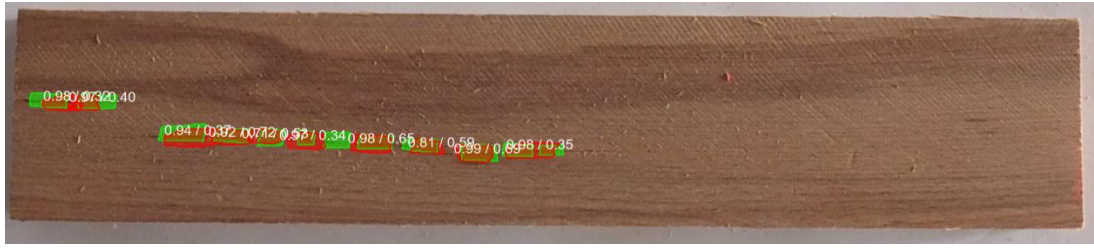
Şekil 4.26. Çatlak modelinin 150 iterasyon sonrası yaptığı tahmin ve maskeleme
