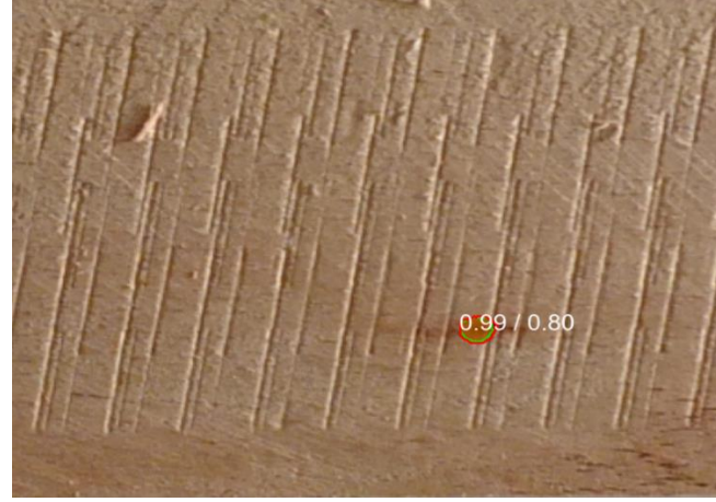
Şekil 4.22. Budak modelinin 250 iterasyon sonrası yaptığı tahmin ve maskeleme
