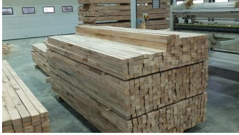
Şekil 2.5. Finger joint işlemi sonrası oluşan latalardan örnek görüntü
