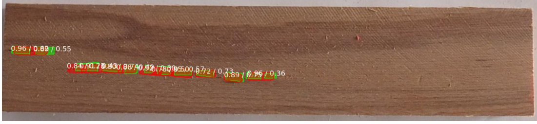
Şekil 4.25. Çatlak modelinin 50 iterasyon sonrası yaptığı tahmin ve maskeleme
