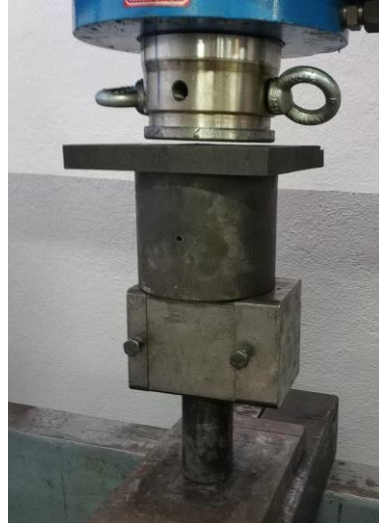
Şekil 5.17. FDM numunesinin sıcak iş takım çeliğine aktarılması
