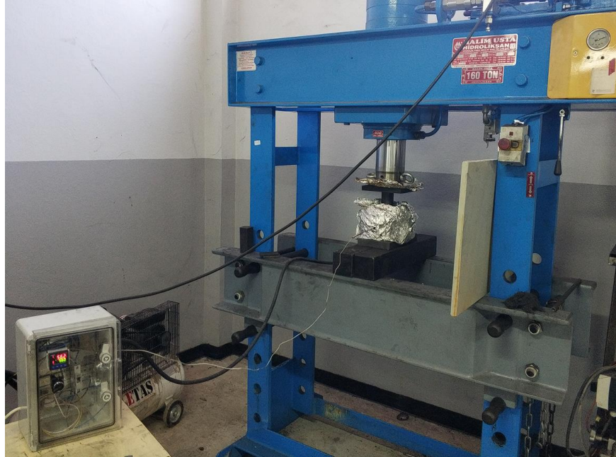
Şekil 5.19. FDM numunesinin basınç altında sinterlenmesi
