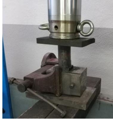
Şekil 5.16. Dikey ayırıcılı kalıba ön basınç uygulanması
