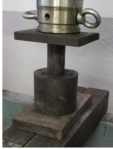
Şekil 5.18. FDM numunesine sıcak iş takım çeliğinde ön basınç uygulanması
