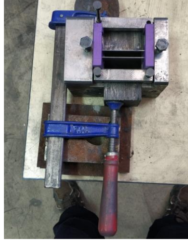
Şekil 5.12. Dikey ayırıcılı kalıba ayırıcıların yerleşimi
