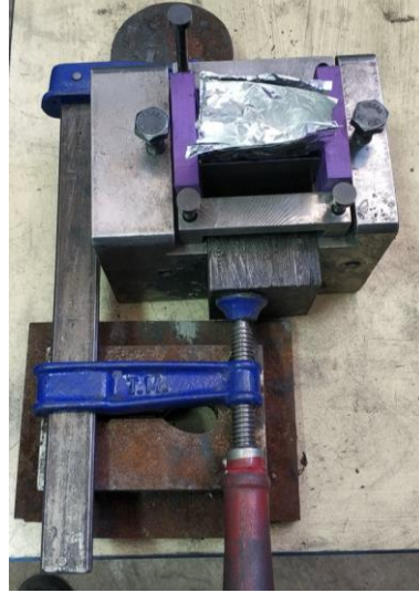
Şekil 5.13. Dikey ayırıcılı kalıba tozların doldurulması
