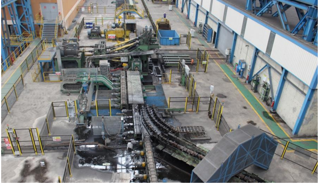
Şekil 4.5. PSM (Precision Sizing Mill-Hassas Boyutlandırma Haddesi).
