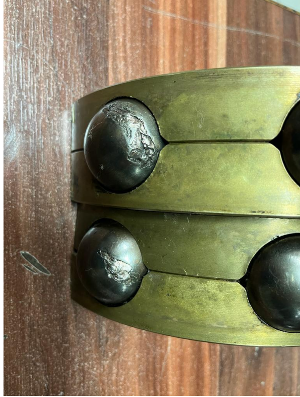
Şekil 6.4. Ön rulman yüzey kusurlu bilyeleri.
