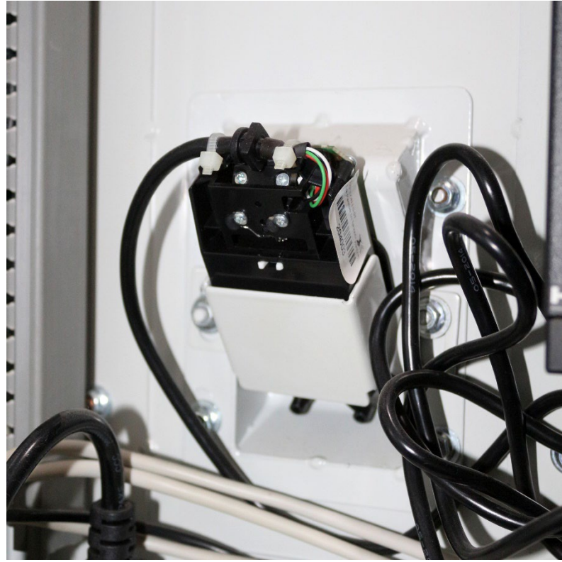
Şekil 28: Optik sensor tipine sahip parmak izi okuyucu (İç görünüm)
