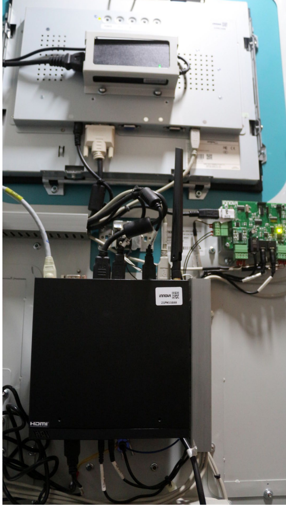
Şekil 24: Multimedya cihazı içerisindeki bilgisayar ve monitör (İç görünüm)
