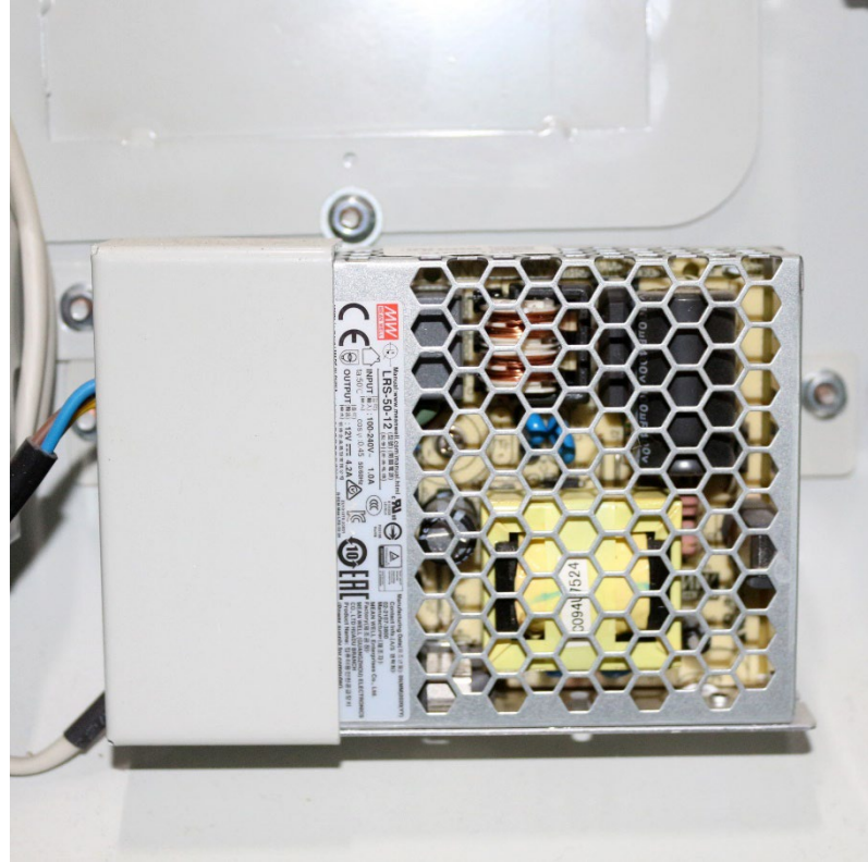
Şekil 26: Güç Kaynağı(İç görünüm)
