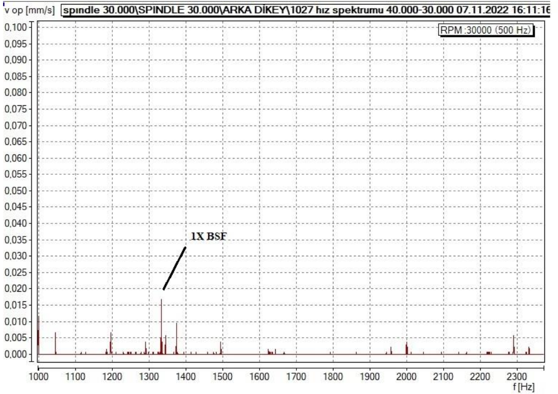
Şekil 13.32. 4B 34.Hat 30.000 RPM iş mili arka 71907 BSF arıza teşhisi (07.11.2022).
