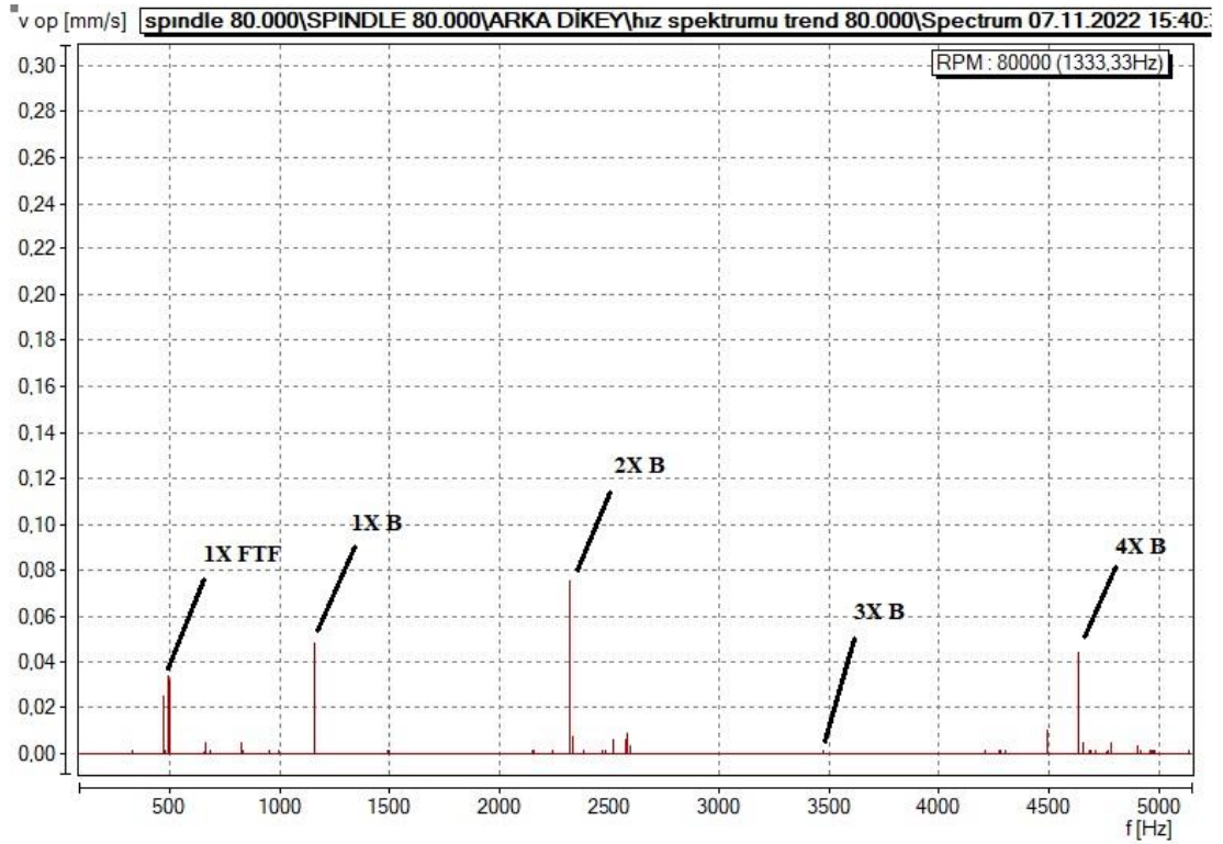
Şekil 13.65. 4A Makara 80.000 RPM iş mili dengesizlik ve arka 71902 FTF arıza teşhisi (07.11.2022).
